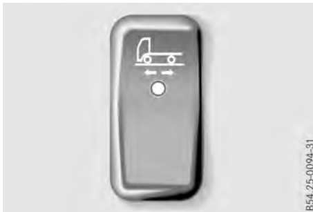
Interruptor del modo de ejecución de maniobras
