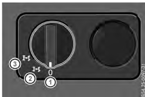
Interruptor del bloqueo longitudinal y transversal (vehículos 6x4)
