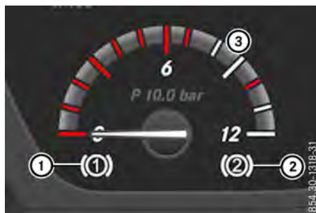
Indicador de presión neumática (tablero INS2014)
