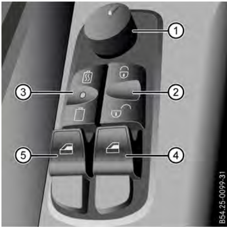
Módulo de interruptores en la puerta del conductor
