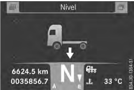
Información de las cargas sobre ejes y bloqueos de compensación (ejemplo)
