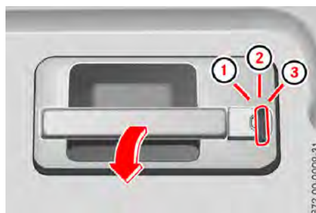
Cerradura y manilla externas (ejecución 2)
