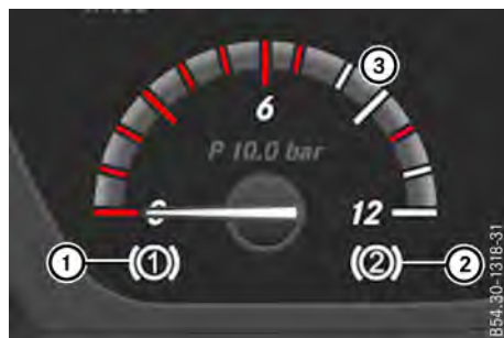
Indicador de presión neumática (tablero INS2014)
