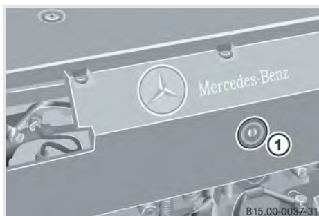
① Motor de arranque y parada del motor (modelos 958.2, motor OM 926 LA)
