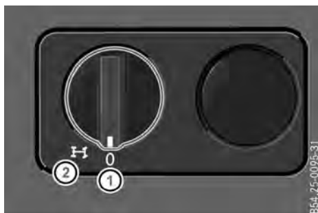
Interruptor del bloqueo transversal (vehículos 4x2 y 6x2)
