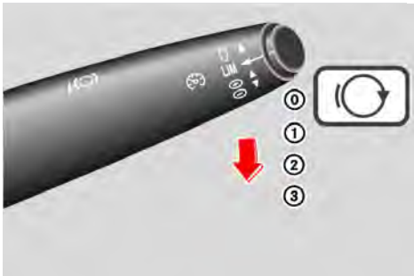
Palanca multifunciones, accionamiento del freno motor
