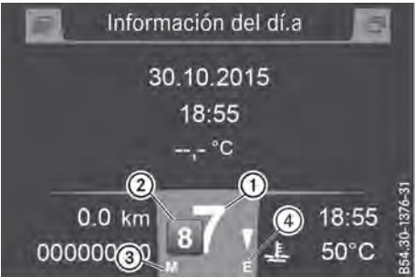
Indicación de la marcha acoplada, tablero INS2014 (ejemplo)
