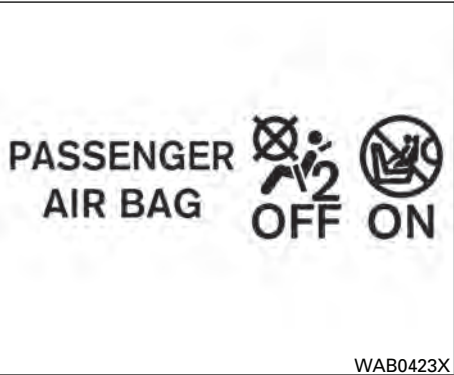
Luz de estado de la bolsa de aire del pasajero delantero (Para México y Puerto Rico)
