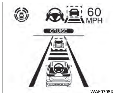
Pantalla de configuración del sistema: vehículo adelante*
