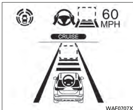
Pantalla configurada del sistema: no se detecta ningún vehículo adelante*
