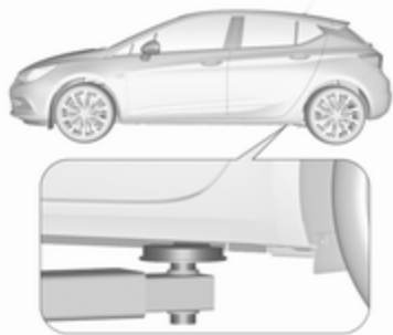
Posición del brazo trasero de la plataforma elevadora centrado bajo el rebaje posterior del estribo.
