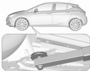
Posición del brazo trasero de la plataforma elevadora centrado bajo el rebaje posterior del estribo.
