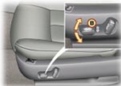
B. Reglaje de la inclinación del cojín del asiento.
