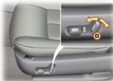
D. Reglaje de la inclinación del respaldo.
