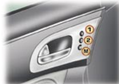
M. Memorización de los reglajes. 1. Recuperación de la primera posición. 2. Recuperación de la segunda posición.
