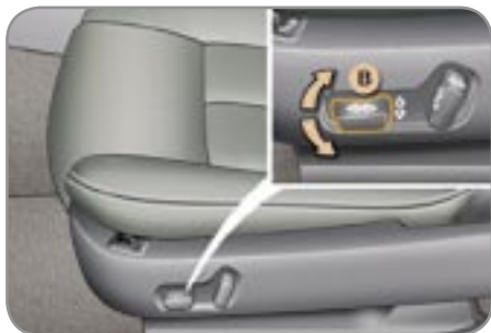
B. Reglaje de la inclinación del cojín del asiento.
