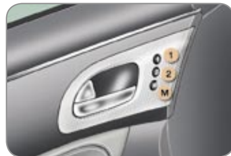
M. Memorización de los reglajes.
