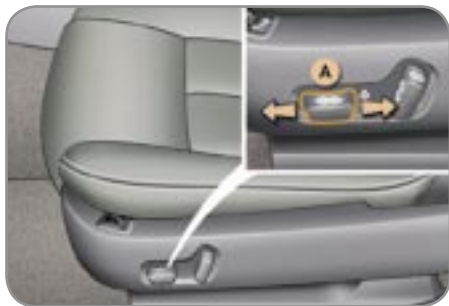
A. Reglaje longitudinal.
