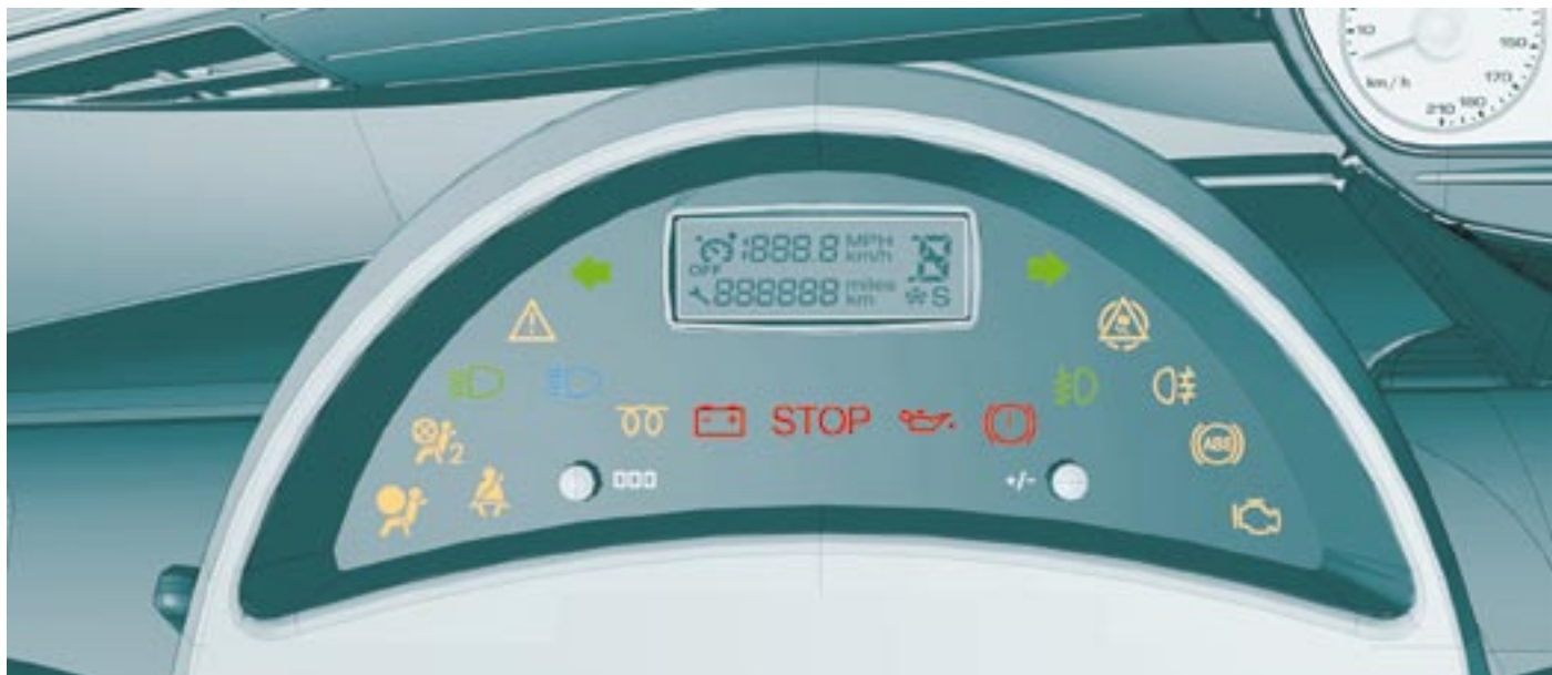
PUESTO DE CONDUCCIÓN BLOQUE DE CONTROL
