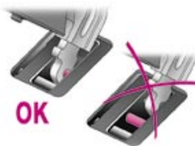
Correcto anclaje de las patas delanteras
