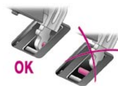
Correcto anclaje de las patas delanteras
