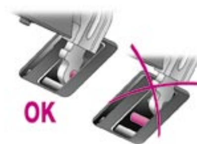
Correcto anclaje de las patas delanteras
