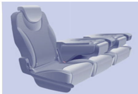
Tipo 2 : Dos plazas con respaldo abatible y cojín de asiento basculable.
