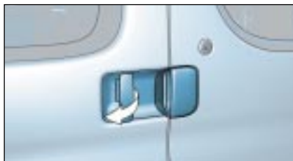
Las puertas laterales Apertura de las puertas desde el exterior
