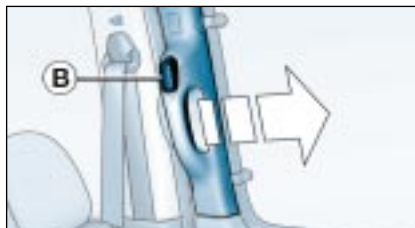
Las puertas laterales Apertura de las puertas desde el interior
