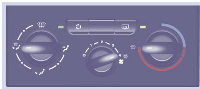
Frontal de la calefacción
