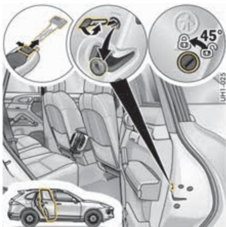
Dispositivo de seguridad para niños en la puerta trasera derecha
