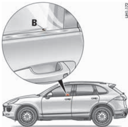
B - Luz piloto del sistema de alarma: ejemplo en la puerta del conductor
