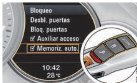
Memorización automática de la configuración en la llave del vehículo (con la función “Memoriz. auto.” activada)
