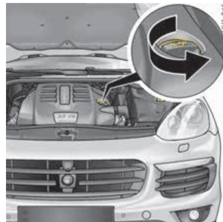
Punto de relleno de aceite motor Cayenne Diesel
