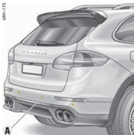
Sensores de ultrasonidos traseros
