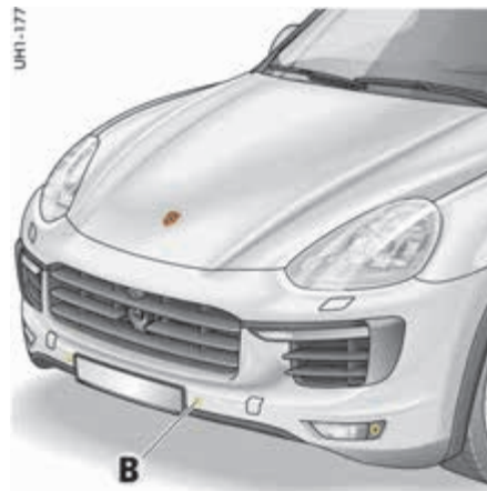
Sensores de ultrasonidos delanteros
