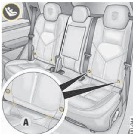
Anclaje ISOFIX de los asientos traseros exteriores
