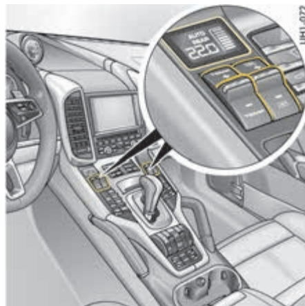
Temperatura y caudal de aire en el panel de mando delantero
