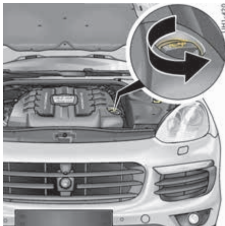
Punto de relleno de aceite motor Cayenne S
