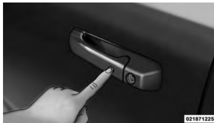
Presione el botón de la manilla de la puerta para bloquear
