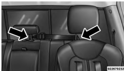
La correa de sujeción a través de la anilla de la correa de sujeción exterior y fijado a la anilla de la correa de sujeción del centro
