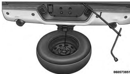
Llave de ruedas y tubo de extensión del gato ensamblados y en posición
