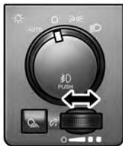
Control del dimmer
