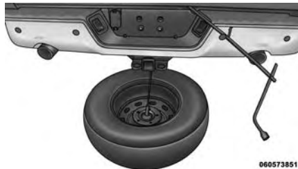
Retiro de la goma de repuesto
