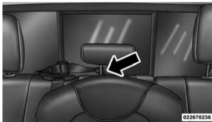
Correa de sujeción a través de la anilla de la correa de sujeción central exterior
