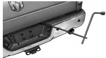
Llave de ruedas y tubo de extensión del gato ensamblados
