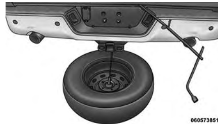
Retiro de la goma de repuesto
