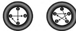
Patrón de torque de las 4 y 5 tuercas/pernos
