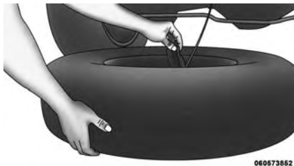
Halamiento y posicionamiento del dispositivo de retención a través de la parte central de la rueda
