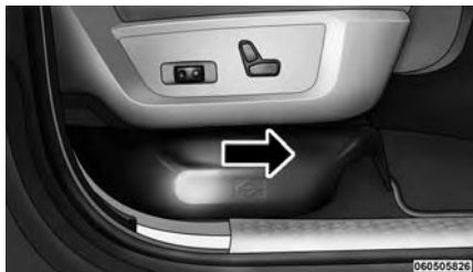
Cubierta de acceso al gato
