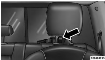
Correa de sujeción a través de la anilla de la correa de sujeción exterior
