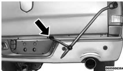
Inserción del tubo de extensión del gato en el orificio de acceso
