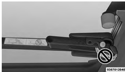
Posición de liberación apropiada del cable de abrazadera
