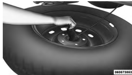
Reinstalación del dispositivo de retención
