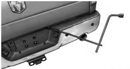
Llave de ruedas y tubo de extensión del gato ensamblados
