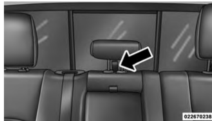
Anilla de la correa de sujeción con apoyacabezas central en posición levantada
