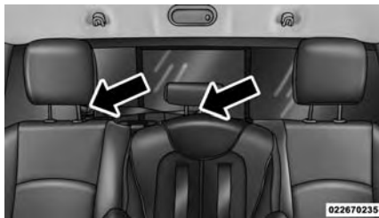
La correa de sujeción a través de la anilla de la correa de sujeción central y fijada a la anilla de la correa de sujeción exterior
