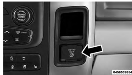
Enchufe del inversor eléctrico
