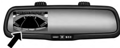
Espejo con control automático de la intensidad de luz con pantalla de la cámara de vista posterior
