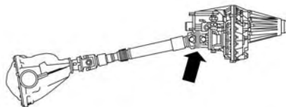
Eje de transmisión delantero de doble unión cardán
