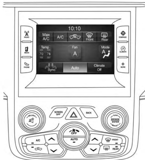
Uconnect 3 con controles de temperatura automática con pantalla táctil de 5 pulgadas
