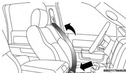
Colocación del cinturón de cadera
