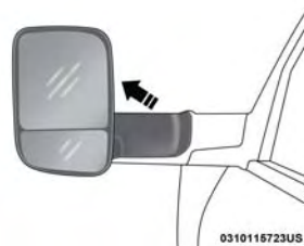
Posición de arrastre del tráiler
