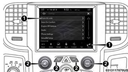
Botones de la pantalla táctil y de la placa frontal de Uconnect 4C/4C NAV
