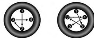
Patrón de torque de las tuercas/pernos de la orejeta cuatro y cinco
