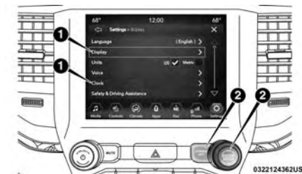
Botones de la pantalla táctil y placa frontal de Uconnect 4/4C NAV con pantalla de 8.4 pulgadas
