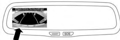
Espejo con control automático de la intensidad de luz con pantalla de la cámara de vista posterior
