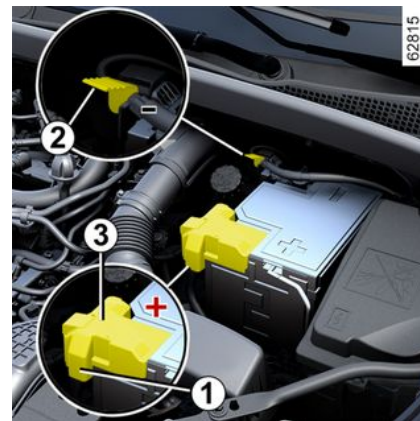
Batería en el compartimento del motor
