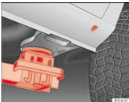
Fig. 177 Punto de apoyo en la parte trasera izquierda para elevar el vehículo con la plataforma
