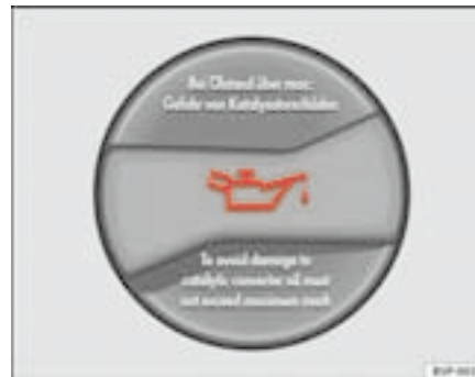
Fig. 143 Tapón de la boca de llenado de aceite del motor en el vano motor
