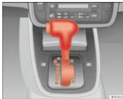
Fig. 128 Consola central: palanca selectora del cambio automático con tecla de bloqueo
