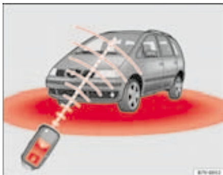
Fig. 60 Radio de acción del mando a distancia por radiofrecuencia
