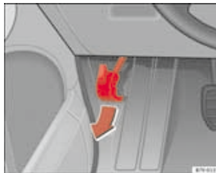
Fig. 139 Detalle de la zona reposapiés del lado del conductor: palanca para el desbloqueo del capó del motor.
