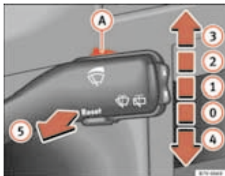
Fig. 80 Palanca del limpiavaparabrisas
