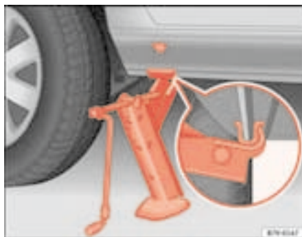
Fig. 162 Posición del gato en la parte trasera derecha
