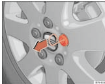
Fig. 158 Extracción de los capuchones con el alambre
