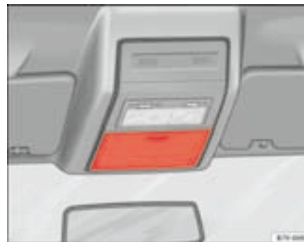
Fig. 104 Portaobjetos en el revestimiento interior del techo
