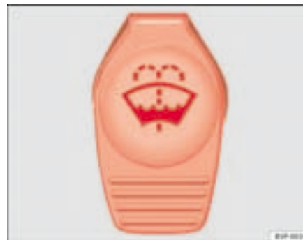
Fig. 145 Tapón del depósito del lavacristales en el vano motor.
