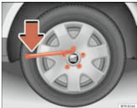
Fig. 159 Cambio de rueda: aflojar los tornillos de rueda
