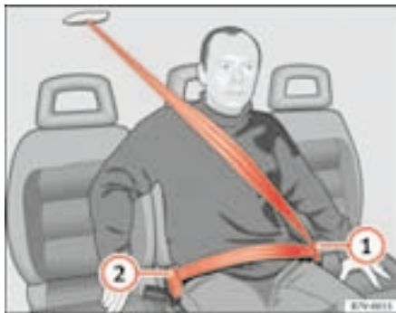
Fig. 17 Desabrochar un cinturón con dos cierres
