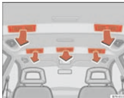
Fig. 122 Difusores de aire frío en el techo
