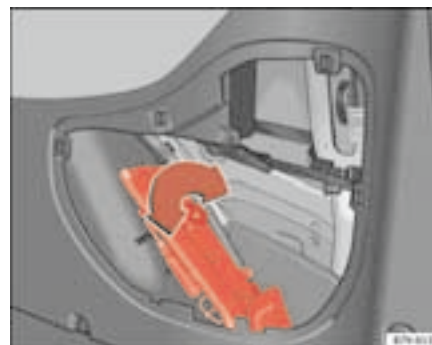
Fig. 152 Ubicación de las herramientas de a bordo
