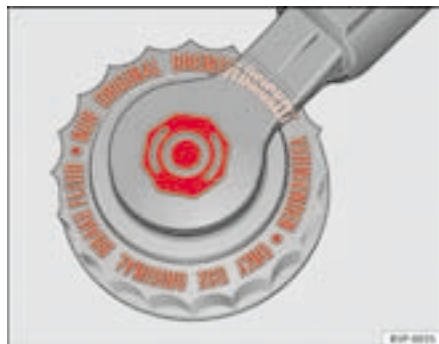
Fig. 149 Tapón del depósito del líquido de frenos en el vano motor
