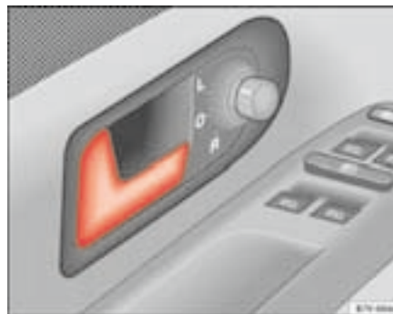
Fig. 58 Manilla interior de la puerta del conductor en la posición normal
