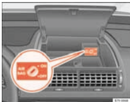
Fig. 28 Interior del compartimento del centro del tablero de instrumentos: interruptor de llave para desactivar los airbags del acompañante
