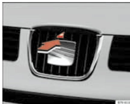
Fig. 140 Detalle de la parrilla del radiador: palanca para abrir el capó del motor.
