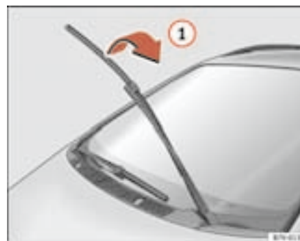
Fig. 147 Desmontaje de los limpiaparabrisas delanteros
