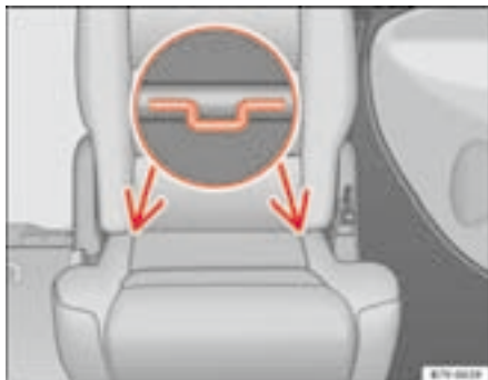
Fig. 33 Argollas de sujeción para los asientos para niños con el sistema ISOFIX en el armazón de los asientos de la segunda fila
