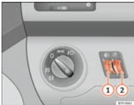
Fig. 72 Tablero de instrumentos: reguladores del alcance de las luces ① y de la iluminación de los instrumentos y los mandos ②
