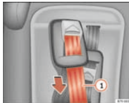
Fig. 38 Asiento integrado para niños: ajuste del cinturón tipo tirantes
