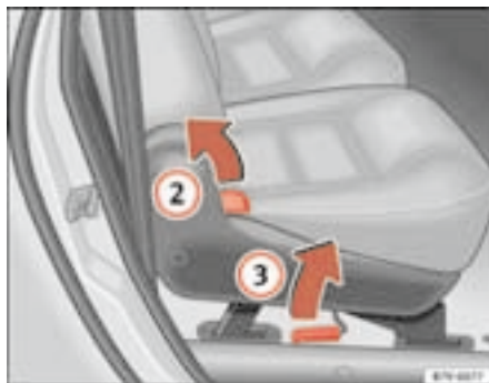
Fig. 91 Lateral del asiento: abatir el respaldo y levantar el asiento
