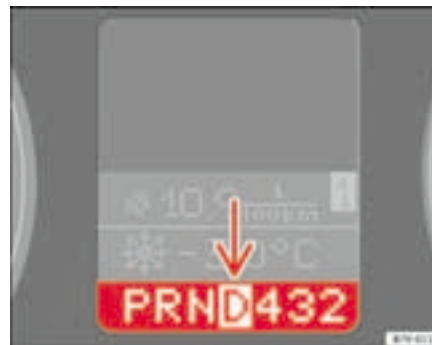
Fig. 129 Cuadro de instrumentos: pantalla con posición actual de la palanca selectora
