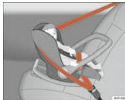
Fig. 30 Asiento para niños del grupo 0 en el asiento trasero, colocado en el sentido contrario a la dirección de la marcha.
