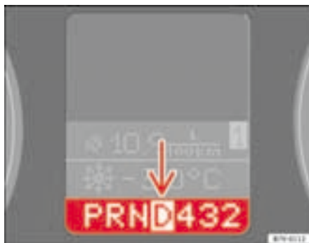
Fig. 131 Cuadro de instrumentos: pantalla con la posición actual de la palanca selectora
