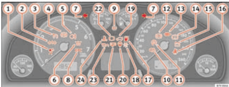
Fig. 48 Testigos de control y de advertencia del cuadro de instrumentos. Algunos de estos testigos pertenecen sólo a determinadas versiones del modelo o forman parte de equipamientos opcionales.
