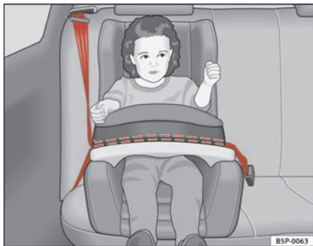
Fig. 31 Asiento para niños del grupo 1 montado en el asiento trasero en la dirección de la marcha.
