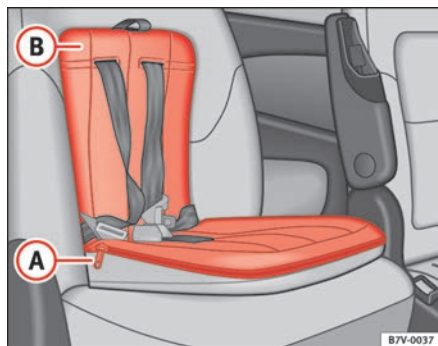
Fig. 42 Detalle del asiento integrado para niños
