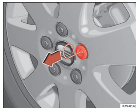
Fig. 156 Extracción de los capuchones con el alambre
