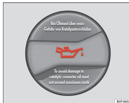
Fig. 141 Tapón de la boca de llenado de aceite del motor en el vano motor
