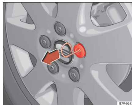
Fig. 157 Extracción de los capuchones con el alambre
