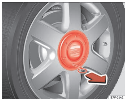
Fig. 156 Desmontaje del tapacubos
