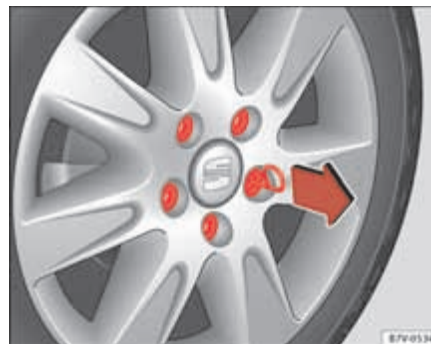
Fig. 177 Quitar los capuchones de los tornillos de la rueda.
