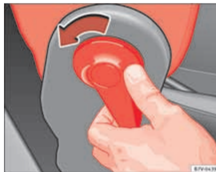
Fig. 83 Desbloquear el respaldo abatible del asiento del acompañante.
