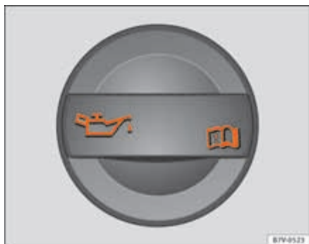
Fig. 166 En el vano motor: Tapón de la boca de llenado del aceite del motor.
