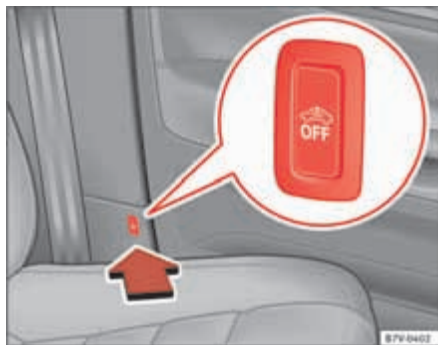
Fig. 48 Junto al asiento del conductor: tecla para desconectar la vigilancia del habitáculo y el sistema antirremolque.
