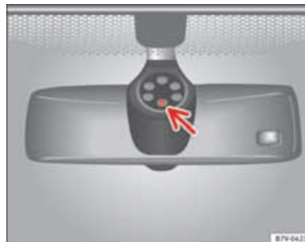
Fig. 70 Superficie sensible del sensor de lluvia.
