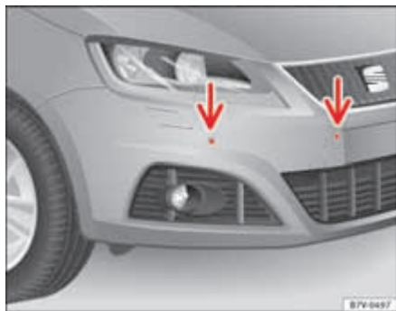
Fig. 140 Sensores del control de aparcamiento en el paragolpes delantero.
