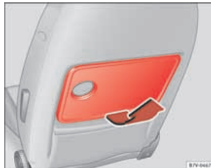
Fig. 111 Mesita plegable en el asiento delantero.
