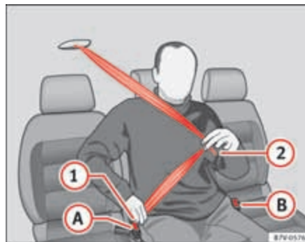
Fig. 12 Abrocharse el cinturón del asiento central de la segunda fila.
