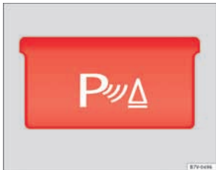
Fig. 139 Detalle de la consola central: tecla para conectar o desconectar el control de la distancia de aparcamiento.
