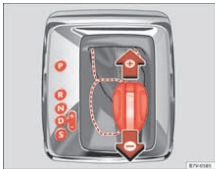
Fig. 132 Palanca selectora en la posición Tiptronic (vehículos con volante a la izquierda). Los vehículos con el volante a la derecha están dispuestos de forma simétrica.
