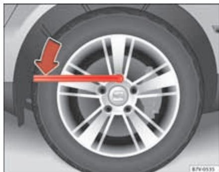
Fig. 178 Cambio de rueda: afloje los tornillos de la rueda.
