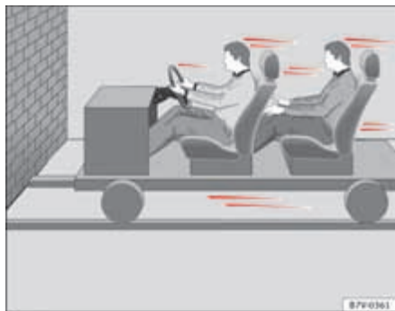
Fig. 5 Vehículo a punto de chocar contra un muro: los ocupantes no llevan abrochado el cinturón.
