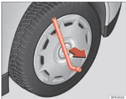
Fig. 176 Desmontar el tapacubos integral.
