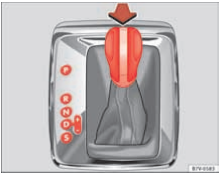
Fig. 130 Vehículos con volante a la izquierda: Palanca selectora del cambio automático con tecla de bloqueo (flecha).
