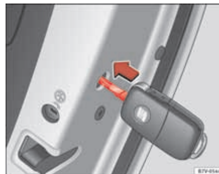
Fig. 187 Bloqueo de emergencia del vehículo con la llave del vehículo.
