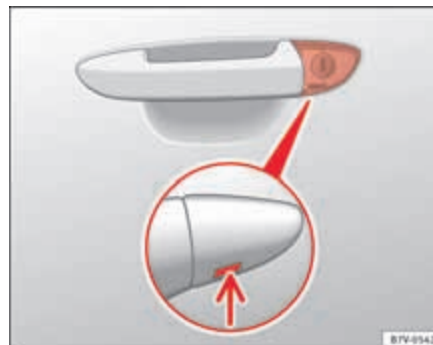
Fig. 185 Maneta de la puerta del conductor: Bombín de cierre oculto.
