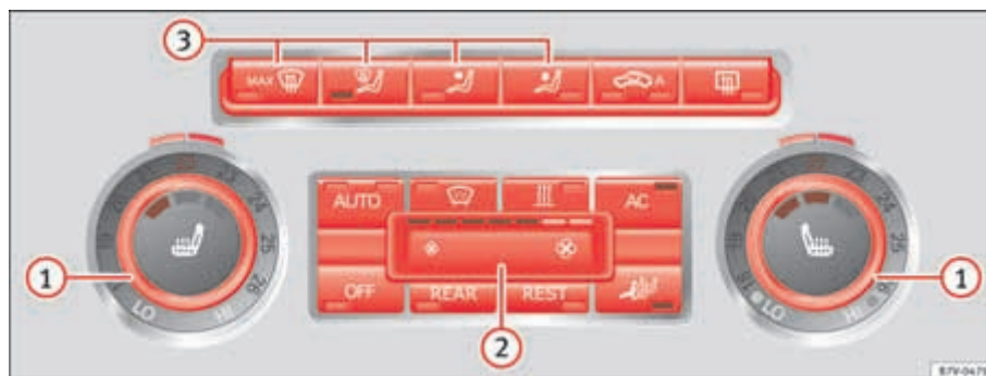
Fig. 122 Detalle de la consola central: Mandos del Climatronic.
