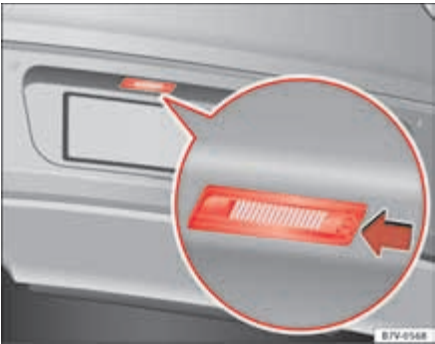
Fig. 210 En el parachoques trasero: iluminación de la matrícula.
