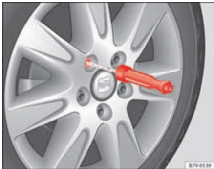
Fig. 182 Cambio de rueda: aflojar los tornillos de la rueda con el mango del destornillador.
