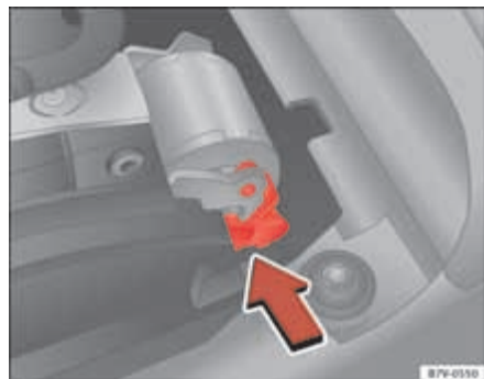
Fig. 193 Desbloqueo de emergencia del bloqueo de la palanca selectora.
