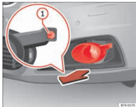
Fig. 204 En la parte derecha del parachoques delantero: Desmontaje de los faros.
