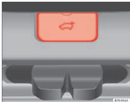
Fig. 188 Desde el maletero: Desmontaje de la tapa del portón trasero.
