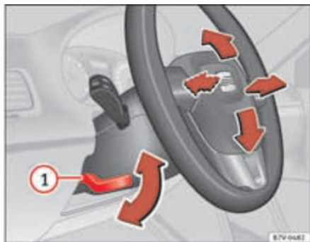
Fig. 125 Ajuste mecánico del volante.
