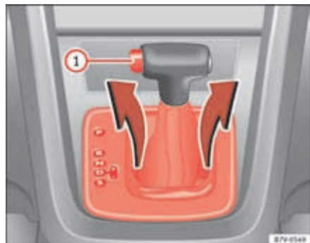
Fig. 192 Desmontar el revestimiento del campo de indicación de las marchas.
