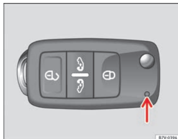
Fig. 42 Testigo de control en la llave de vehículos con puertas corredizas eléctricas.
