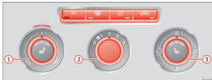
Fig. 122 Detalle de la consola central: Mandos del Aire acondicionado manual eléctrico.
