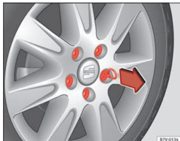
Fig. 182 Quitar los capuchones de los tornillos de la rueda.
