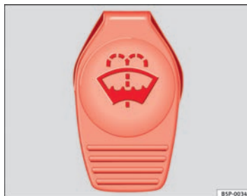
Fig. 70 En el vano motor: tapón del depósito de lavacrystales.
