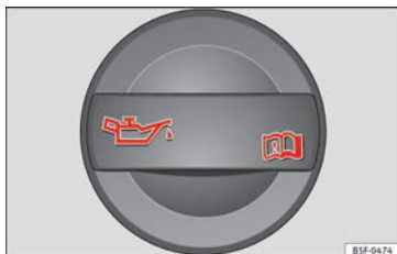
Fig. 166 En el vano motor: tapón de la boca de llenado del aceite de motor.
