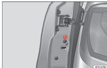
Fig. 197 En la parte frontal de la puerta del acompañante: bloqueo de emergencia, oculto por una junta de goma.
