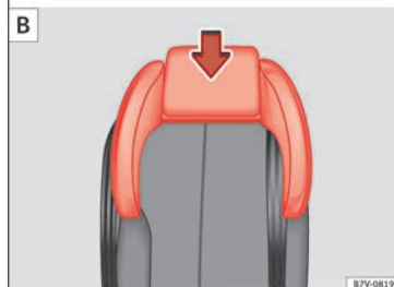
Fig. 29 Asiento integrado para niños: colocar el apoyacabezas sobre el apoyacabezas lateral A y montar B.
