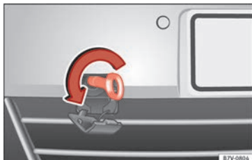
Fig. 194 En la parte derecha del parachoques delantero: enroscar la argolla de remolque.
