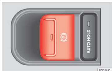
Fig. 128 Detalle de la consola central: conmutador del freno de estacionamiento electrónico.
