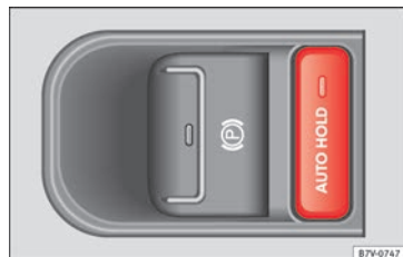
Fig. 135 Detalle de la consola central: tecla del Auto Hold.
