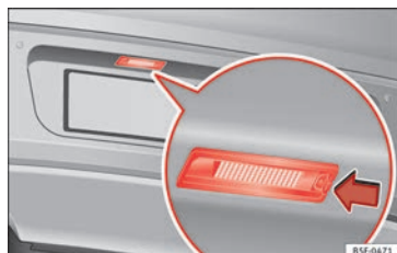
Fig. 221 En el parachoques trasero: iluminación de la matrícula.
