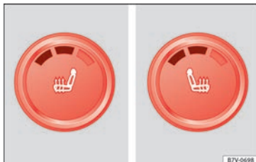
Fig. 80 Detalle de la consola central: mandos para la calefacción de los asientos delanteros, aquí con el segundo nivel de temperatura ajustado.
