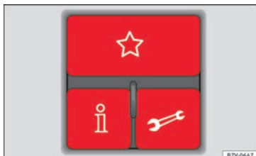
Fig. 38 Módulo de tres teclas del techo: mandos del sistema de gestión del teléfono.
