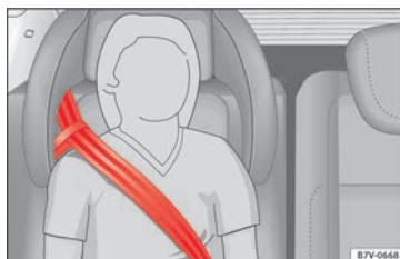
Fig. 31 Asiento integrado para niños: recorrido de la banda del cinturón con asa-guía.
