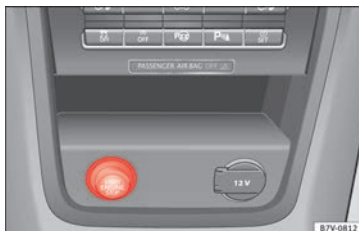
Fig. 126 En la consola central: pulsador de arranque del sistema de cierre y arranque sin llave Keyless Access. En los vehículos con el volante a la derecha, la disposición es simétrica.
