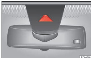
Fig. 149 En el parabrisas: área de campo visual de la cámara del sistema de aviso de salida del carril.
