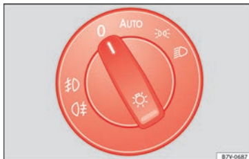
Fig. 60 Al lado del volante: representación de algunas variantes del mando de las luces.
