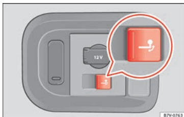
Fig. 153 Lado derecho del maletero: botón para bascular eléctricamente la rótula del enganche.
