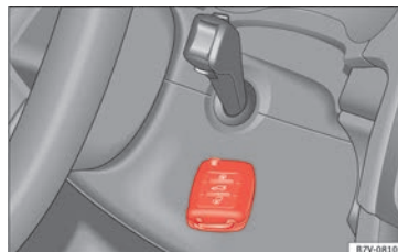
Fig. 127 Arranque de emergencia en vehículos con KESSY.
