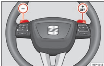
Fig. 132 Volante con dos levas para el Tiptronic.
