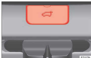
Fig. 199 Desde el maletero: desmontaje de la tapa del portón trasero.
