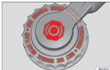
Fig. 170 En el vano motor: tapón del depósito del líquido de frenos.
