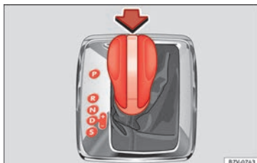
Fig. 130 Palanca selectora del cambio automático con tecla de bloqueo (flecha).
