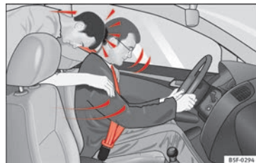
Fig. 8 El ocupante del asiento trasero que no lleve puesto el cinturón de seguridad se verá lanzado hacia adelante, sobre el conductor que sí lleva el cinturón.
