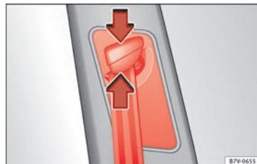
Fig. 12 Junto a los asientos delanteros: regulador de la altura del cinturón.
