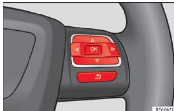
Fig. 37 Volante multifunción: teclas para utilizar los menús del cuadro de instrumentos.
