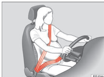
Fig. 10 Colocación de la banda del cinturón en el caso de mujeres embarazadas.
