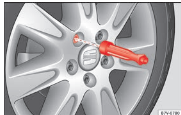
Fig. 189 Cambio de rueda: aflojar los tornillos de la rueda con el mango del destornillador.
