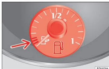
Fig. 158 En el cuadro de instrumentos: indicador del nivel de combustible para gasolina y diésel.
