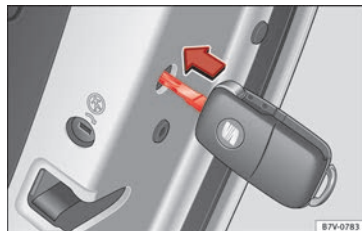
Fig. 198 Bloqueo de emergencia del vehículo con la llave del vehículo.
