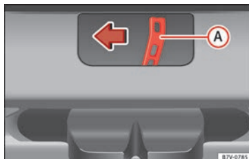
Fig. 200 Desde el maletero: desbloqueo de emergencia del portón trasero.
