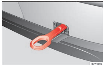
Fig. 195 En el parachoques trasero, en el lado derecho: Argolla de remolque enroscada.
