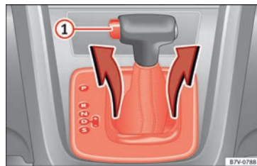
Fig. 203 Desmontar el revestimiento del campo de indicación de las marchas.
