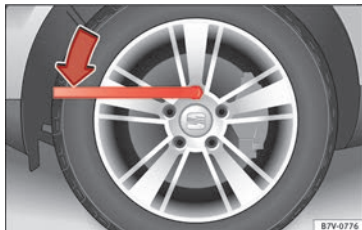
Fig. 185 Cambio de rueda: afloje los tornillos de la rueda.
