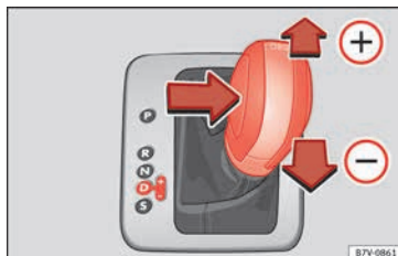
Fig. 204 Palanca selectora en la posición Tiptronic (vehículos con volante a la izquierda). Los vehículos con el volante a la derecha están dispuestos de forma simétrica.
