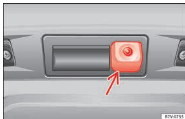
Fig. 215 En el portón trasero: ubicación de la cámara del asistente para marcha atrás.
