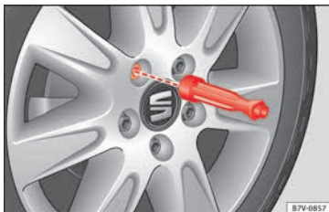
Fig. 72 Cambio de rueda: aflojar los tornillos de la rueda con el mango del destornillador.
