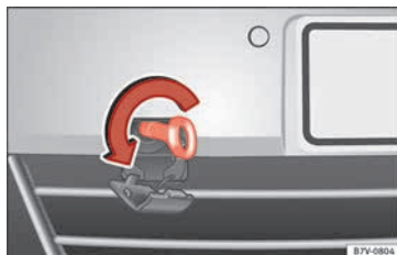
Fig. 104 En la parte derecha del parachoques delantero: enroscar la argolla de remolque.
