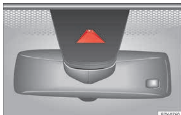
Fig. 220 En el parabrisas: área de campo visual de la cámara del sistema de aviso de salida del carril.
