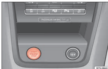
Fig. 200 En la consola central: pulsador de arranque del sistema de cierre y arranque sin llave Keyless Access. En los vehículos con el volante a la derecha, la disposición es simétrica.
