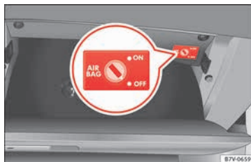
Fig. 28 En la guantera, en el lado del acompañante: interruptor de llave para activar y desactivar el airbag frontal del acompañante.
