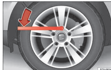
Fig. 68 Cambio de rueda: afloje los tornillos de la rueda.
