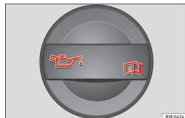
Fig. 56 Tapón de la boca de llenado de aceite del motor en el vano motor.
