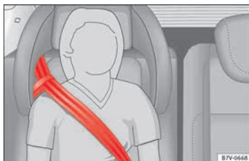
Fig. 97 Asiento integrado para niños: recorrido de la banda del cinturón con asa-guía.
