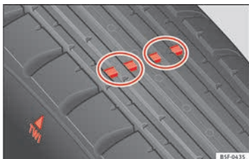
Fig. 253 Perfil del neumático: indicadores de desgaste.
