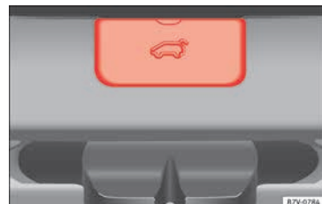
Fig. 8 Desde el maletero: desmontaje de la tapa del portón trasero.
