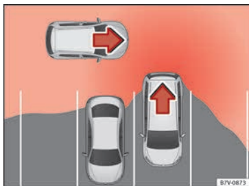
Fig. 225 Representación esquemática del asistente de desaparcamiento: zona vigilada alrededor del vehículo que está desaparcando.
