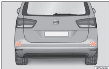
Fig. 222 Vista trasera del vehículo: zonas de los sensores de radar.
