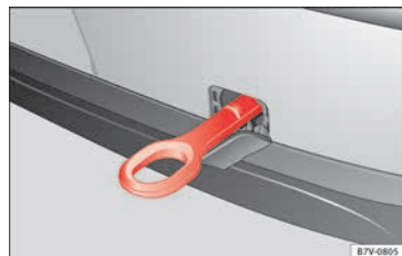
Fig. 105 En el parachoques trasero, en el lado derecho: Argolla de remolque enroscada.
