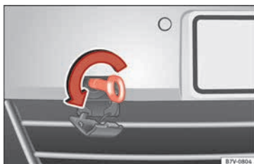
Fig. 73 En la parte derecha del parachoques delantero: enroscar la argolla de remolque.
