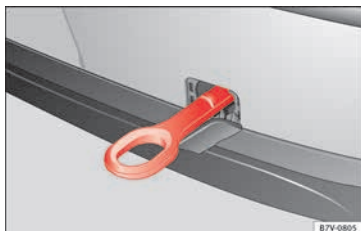
Fig. 74 En el parachoques trasero, en el lado derecho: Argolla de remolque enroscada.
