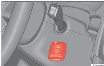
Fig. 201 Arranque de emergencia en vehículos con Keyless Access.
