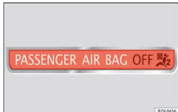
Fig. 92 Testigo de control en el tablero de instrumentos para la desactivación del airbag frontal del acompañante.
