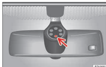
Fig. 146 Superficie sensible del sensor de lluvia.
