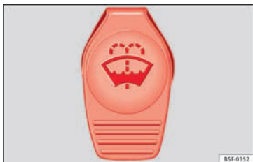
Fig. 248 En el vano motor: tapón del depósito del lavacristales.
