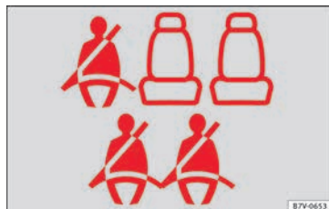
Fig. 84 Ejemplo de indicación del estado del cinturón en las plazas traseras (aquí, en un vehículo de 7 plazas) en el cuadro de instrumentos: arriba, la segunda fila; abajo, la tercera fila de asientos.
