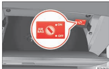
Fig. 93 En la guantera, en el lado del acompañante: interruptor de llave para activar y desactivar el airbag frontal del acompañante.
