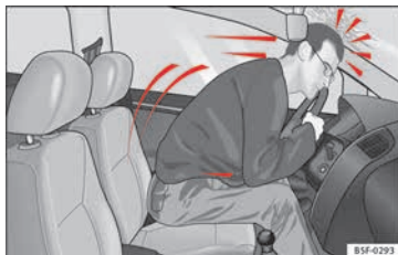
Fig. 86 El conductor que no lleve puesto el cinturón de seguridad se verá lanzado hacia delante.
