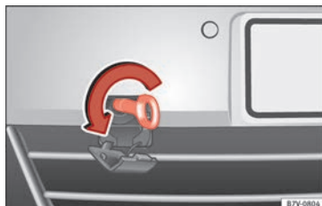
Fig. 103 En la parte derecha del parachoques delantero: enroscar la argolla de remolque.
