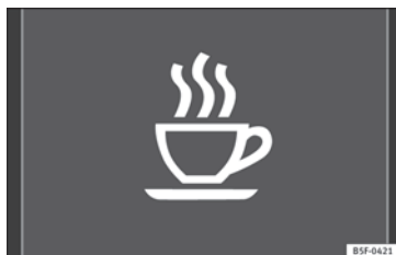
Fig. 226 En la pantalla del cuadro de instrumentos: símbolo de detección del cansancio.
