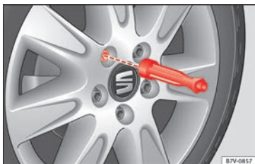
Fig. 71 Cambio de rueda: aflojar los tornillos de la rueda con el mango del destornillador.
