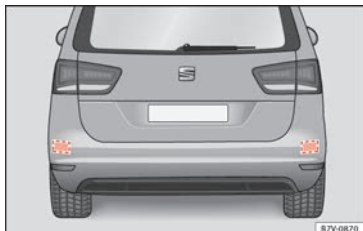
Fig. 221 Vista trasera del vehículo: zonas de los sensores de radar.
