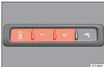
Fig. 157 Teclas de memoria en la parte exterior del asiento del conductor.
