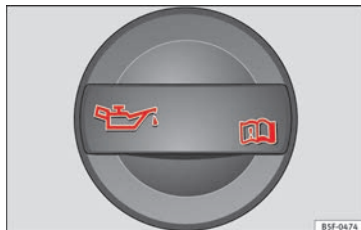
Fig. 242 En el vano motor: tapón de la boca de llenado del aceite de motor.
