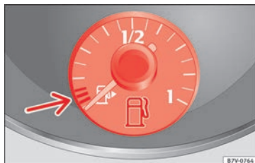
Fig. 234 En el cuadro de instrumentos: indicador del nivel de combustible para gasolina y diésel.
