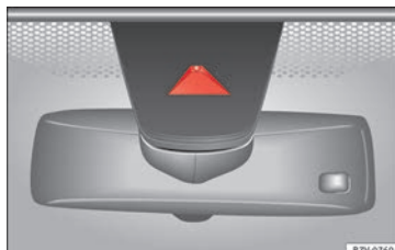
Fig. 219 En el parabrisas: área de campo visual de la cámara del sistema de aviso de salida del carril.
