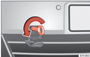
Fig. 72 En la parte derecha del parachoques delantero: enroscar la argolla de remolque.
