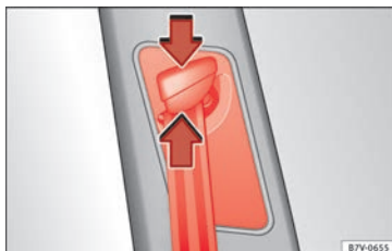
Fig. 90 Junto a los asientos delanteros: regulador de la altura del cinturón.
