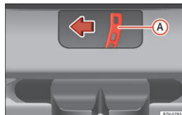
Fig. 9 Desde el maletero: desbloqueo de emergencia del portón trasero.
