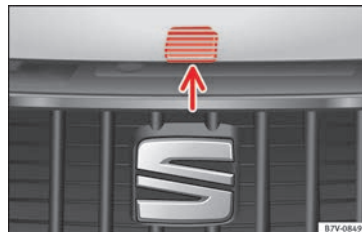
Fig. 239 Palanca de desbloqueo para la apertura del capó del motor en la parrilla del radiador.
