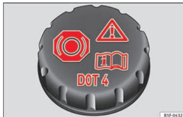
Fig. 246 En el vano motor: tapón del depósito del líquido de frenos.
