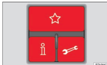
Fig. 123 Módulo de tres teclas del techo: mandos del sistema de gestión del teléfono.
