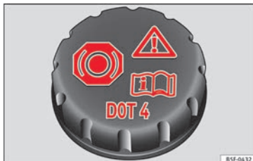
Fig. 57 Vano motor: tapón del depósito del líquido de frenos.
