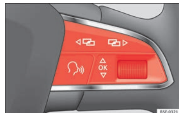
Fig. 45 Volante multifunción: teclas para utilizar los menús del cuadro de instrumentos.
