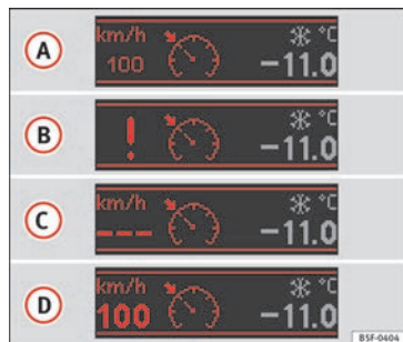
Fig. 218 Pantalla del cuadro de instrumentos: indicaciones de estado del GRA.
