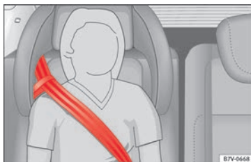
Fig. 96 Asiento integrado para niños: recorrido de la banda del cinturón con asa-guía.
