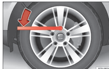
Fig. 67 Cambio de rueda: afloje los tornillos de la rueda.
