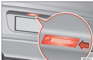
Fig. 115 En el parachoques trasero: iluminación de la matrícula.
