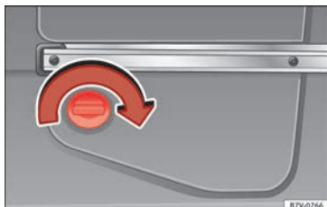
Fig. 236 En la parte trasera izquierda del maletero: depósito de AdBlue, detrás de una cubierta.
