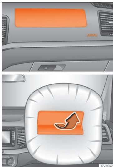
Fig. 17 Airbag del acompañante en el tablero de instrumentos.
