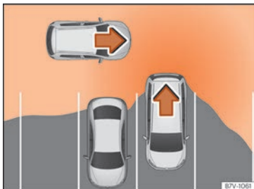
Fig. 264 Representación esquemática del asistente de desaparcamiento: zona vigilada alrededor del vehículo que está desaparcando.
