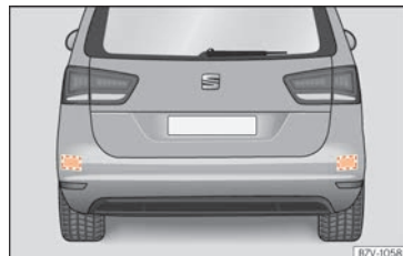
Fig. 261 Vista trasera del vehículo: zonas de los sensores de radar.
