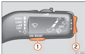
Fig. 81 Palanca del limpiaparabrisas: teclas para utilizar los menús del cuadro de instrumentos.
