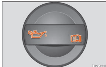
Fig. 290 Tapón de la boca de llenado de aceite del motor en el vano motor.
