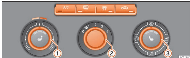
Fig. 174 En la consola central: mandos del aire acondicionado manual.
