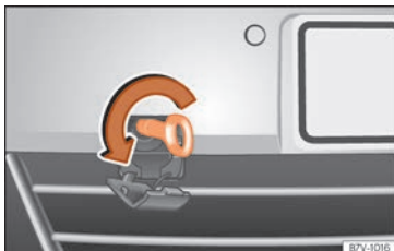
Fig. 56 En la parte derecha del parachoques delantero: enroscar la argolla de remolque.
