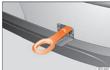
Fig. 57 En el lado derecho del paragolpes trasero: argolla de remolque enroscada.
