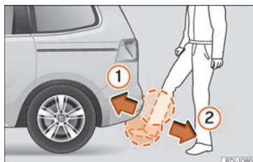
Fig. 106 Portón del maletero con apertura controlada por sensor (Easy Open).
