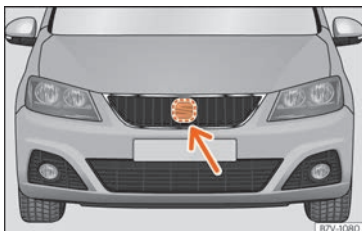
Fig. 247 En el frontal tras el emblema de SEAT: sensor de radar.
