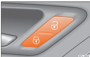
Fig. 90 Puerta del conductor: conmutador del cierre centralizado.
