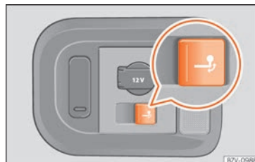
Fig. 280 En el lado derecho del maletero: tecla para desbloquear el gancho de remolque.
