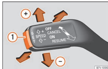
Fig. 245 A la izquierda de la columna de la dirección: tercera palanca para manejar el GRA.
