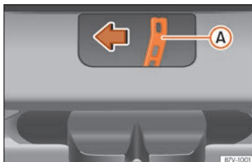
Fig. 108 Detalle del maletero: desbloqueo de emergencia.
