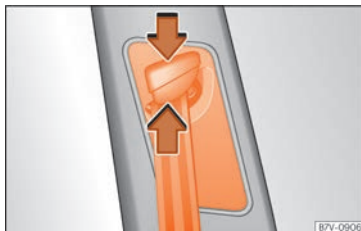
Fig. 15 Junto a los asientos delanteros: regulador de la altura del cinturón.
