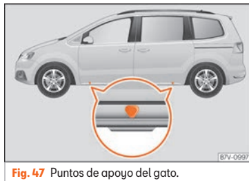
Fig. 47 Puntos de apoyo del gato.
