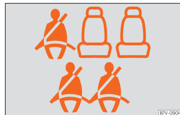
Fig. 6 Ejemplo de indicación del estado del cinturón en las plazas traseras (aquí, en un vehículo de 7 plazas) en el cuadro de instrumentos: arriba, la segunda fila; abajo, la tercera fila de asientos.
