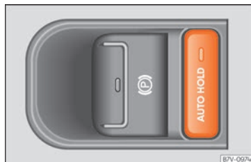
Fig. 266 Detalle de la consola central: tecla del Auto Hold.
