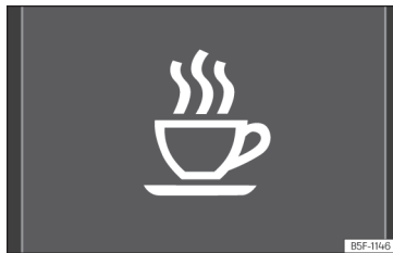
Fig. 76 En la pantalla del cuadro de instrumentos: símbolo de detección de cansancio.
