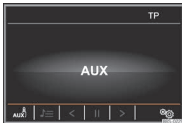
Fig. 210 Modo Media: fuente de audio externa conectada a la toma AUX-IN.
