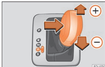
Fig. 239 Palanca selectora en la posición Tiptronic (vehículos con volante a la izquierda). Los vehículos con el volante a la derecha están dispuestos de forma simétrica.
