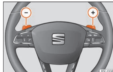
Fig. 240 Volante con dos levas para el Tiptronic.
