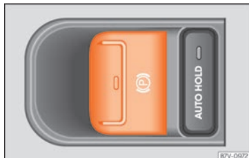
Fig. 265 En la consola central: tecla del freno de estacionamiento electrónico.
