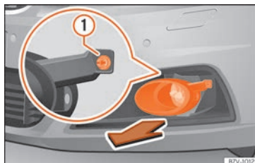
Fig. 66 En la parte derecha del parachoques delantero: desmontaje de los faros.
