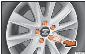
Fig. 43 Rueda: tornillos de la rueda con capuchones.
