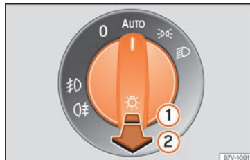
Fig. 115 Tablero de instrumentos: mando de las luces.
