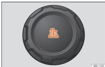
Fig. 292 Vano motor: tapón del depósito de expansión del líquido refrigerante.
