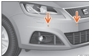
Fig. 272 Sensores del control de aparcamiento en el paragolpes delantero.
