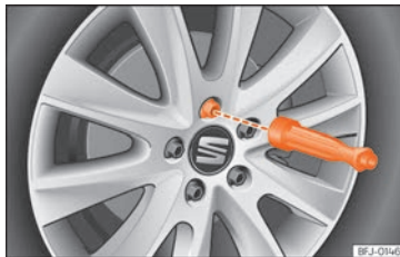
Fig. 49 Cambio de rueda: desenroscar los tornillos de rueda con el mango del destornillador.
