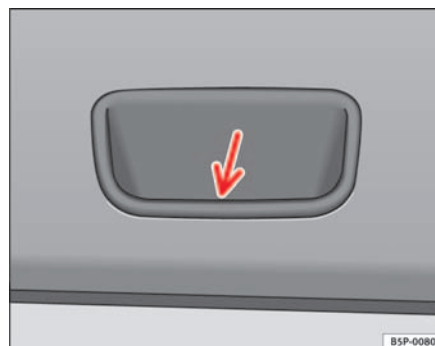
Fig. 67 Detalle del guardacavidad interior del portón trasero: cavidad para tirar
