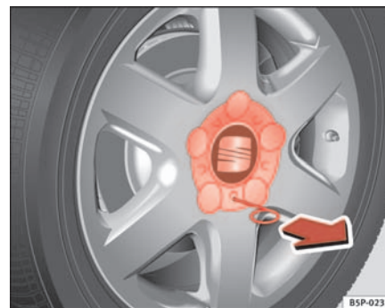
Fig. 171 Cambio de rueda: Retirar el embellecedor de la rueda
