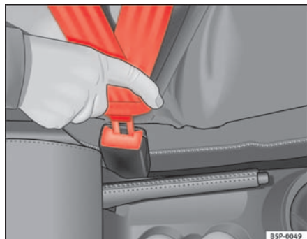
Fig. 12 Cierre y lengüeta del cinturón de seguridad
