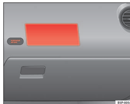
Fig. 19 Airbag del acompañante en el tablero de instrumentos
