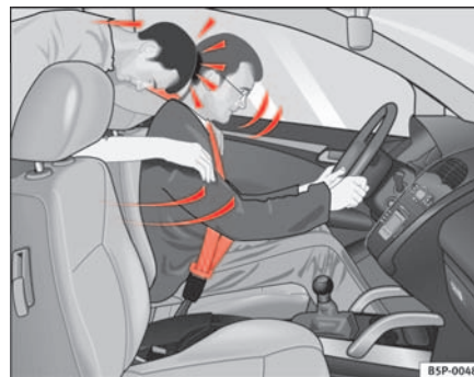
Fig. 10 El ocupante del asiento trasero que no lleve puesto el cinturón de seguridad se verá lanzado hacia adelante sobre el conductor que sí lleva el cinturón.
