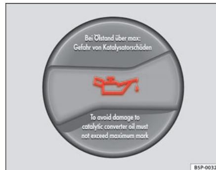
Fig. 161 Tapón de la boca de llenado de aceite del motor en el vano motor ►
