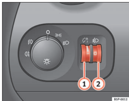
Fig. 75 Tablero de instrumentos: reguladores de la iluminación de instrumentos y mandos y del alcance de los faros
