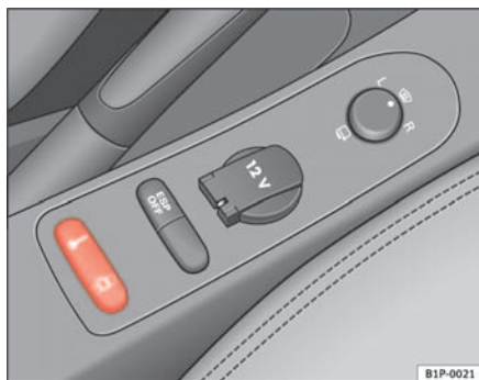
Fig. 60 Detalle de la consola central: pulsador del cierre centralizado
