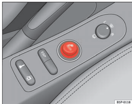
Fig. 114 Encendedor alojado en la toma de corriente de la consola central anterior
