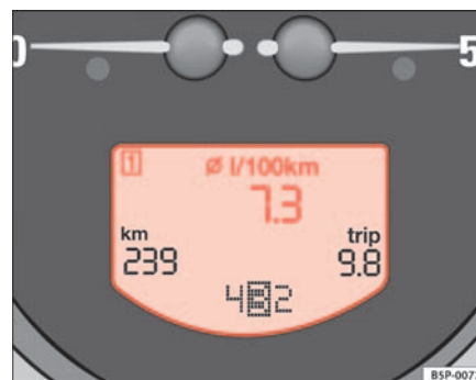
Fig. 40 Pantalla digital del cuadro de instrumentos: indicador consumo medio de combustible
