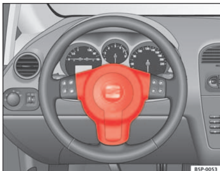
Fig. 18 Airbag del conductor en el volante
