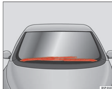
Fig. 164 Limpiacristales en la posición para realizar el cambio
