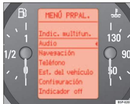
Fig. 44 Pantalla digital del cuadro de instrumentos: Menú principal
