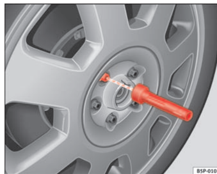
Fig. 175 Cambio de rueda: Útil de hexágono interior para girar los tornillos
