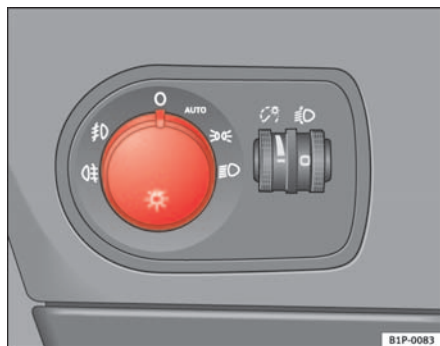
Fig. 74 Encendido automático de luces
