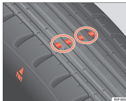
Fig. 168 Indicadores de desgaste del perfil del neumático
