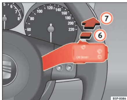
Fig. 87 Palanca del limpia-lavacristales: limpiacristal
