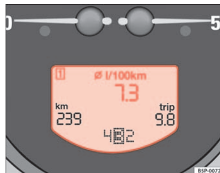
Fig. 42 Pantalla digital del cuadro de instrumentos: indicador consumo medio de combustible.
