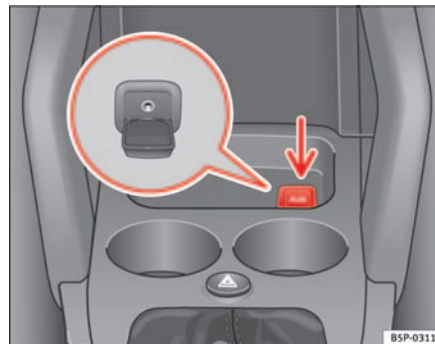
Fig.117 Conector para la entrada auxiliar de audio
