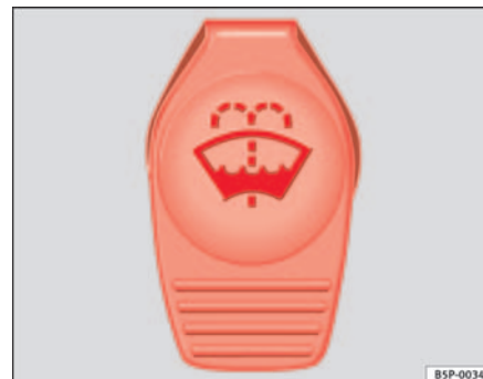
Fig. 163 Tapón del depósito del lavacristales en el vano motor.
