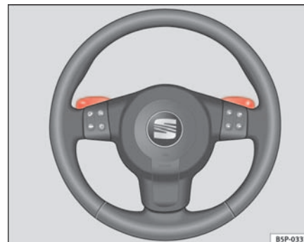
Fig. 139 Volante con palancas para cambio automático
