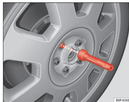
Fig. 178 Cambio de rueda: Útil de hexágono interior para girar los tornillos
