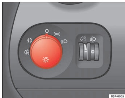
Fig. 73 Detalle del tablero de instrumentos: mando de las luces, faros antiniebla y luz trasera antiniebla
