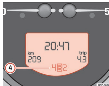
Fig. 37 Detalle del cuadro de instrumentos: pantalla con indicador de marchas del Tiptronic
