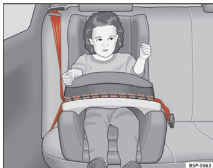
Fig. 29 Asiento para niños del grupo 1 montado en el asiento trasero en la dirección de la marcha.
