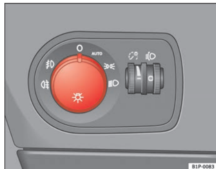
Fig. 74 Encendido automático de luces
