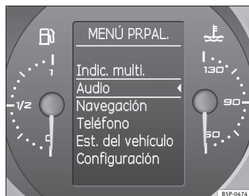
Fig. 47 Pantalla digital del cuadro de instrumentos: Menú principal
