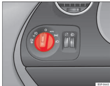
Fig. 74 Encendido automático de luces
