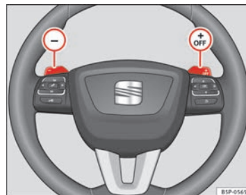
Fig. 148 Volante con palancas para cambio automático
