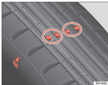
Fig. 173 Indicadores de desgaste del perfil del neumático
