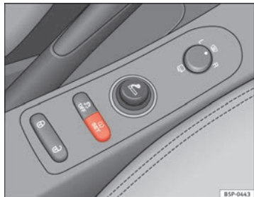
Fig. 50 Consola central: tecla del sistema de control de los neumáticos
