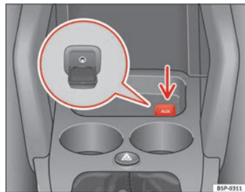
Fig. 119 Conector para la entrada auxiliar de audio
