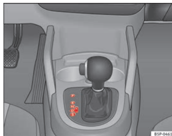
Fig. 143 Consola central: palanca selectora del cambio automático / cambio automático DSG
