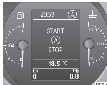
Fig. 140 Indicación en la pantalla del cuadro de instrumentos durante el funcionamiento Start-Stop.
