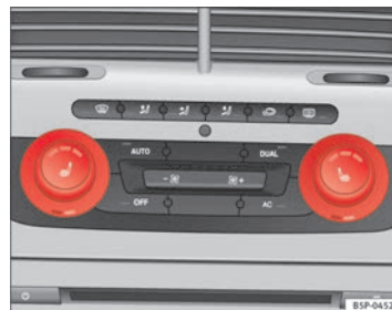
Fig. 96 Calefacción asientos delanteros con Climatronic
