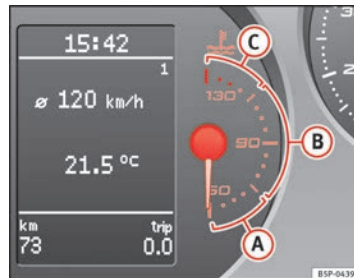
Fig. 35 Cuadro de instrumentos: indicador de la temperatura del líquido refrigerante del motor
