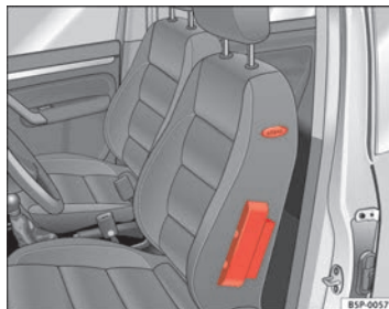
Fig. 22 Airbag lateral en el asiento del conductor
