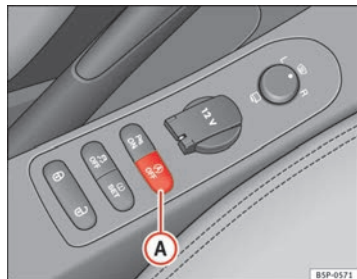
Fig. 139 Detalle del pulsador del funcionamiento Start-Stop.
