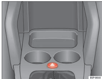
Fig. 77 Tablero de instrumentos: conmutador de los intermitentes de emergencia
