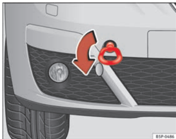
Fig. 205 Atornillado de la argolla de remolque en la parte delantera derecha del vehículo
