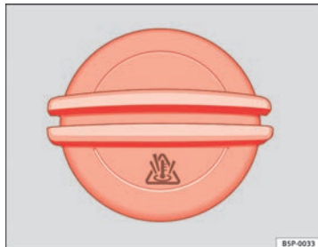
Fig. 166 Tapón del depósito de expansión del líquido refrigerante en el vano motor
