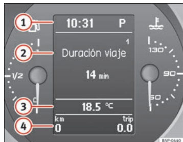
Fig. 38 Pantalla digital del cuadro de instrumentos
