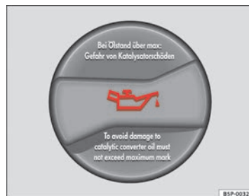
Fig. 165 Tapón de la boca de llenado de aceite del motor en el vano motor
