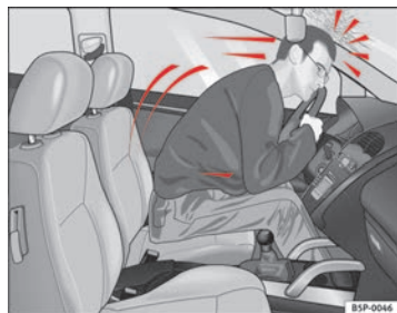
Fig. 9 El conductor que no lleve puesto el cinturón de seguridad se verá lanzado hacia delante
