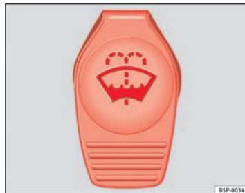
Fig. 167 Tapón del depósito del lavacristales en el vano motor.
