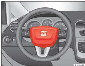
Fig. 18 Airbag del conductor en el volante
