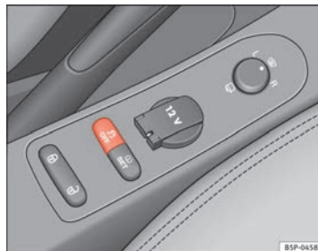
Fig. 136 Detalle de la consola central: tecla ESP
