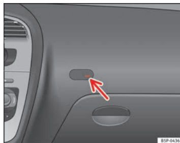
Fig. 27 Testigo de control de la desactivación del airbag del acompañante
