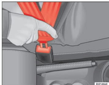
Fig. 12 Cierre y lengüeta del cinturón de seguridad
