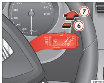
Fig. 89 Palanca del limpiacristales: limpialuneta
