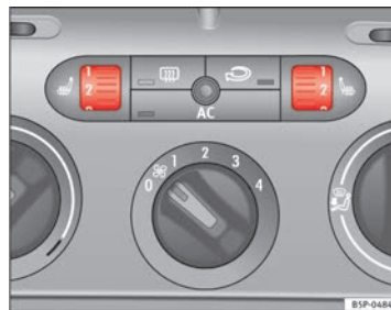
Fig. 96 Ruedecillas moleteadas de la calefacción de los asientos delanteros
