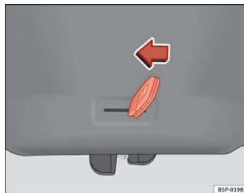
Fig. 68 Portón trasero: apertura de emergencia
