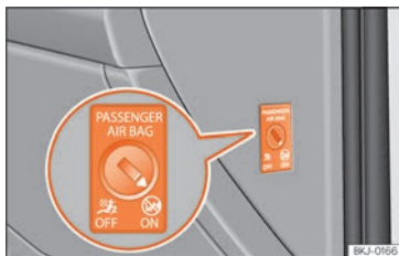
Fig. 94 Conmutador con llave para activar y desactivar el airbag del acompañante.
