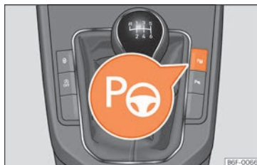
Fig. 248 En la consola central: tecla para conectar el sistema de aparcamiento asistido.
