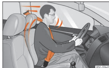
Fig. 89 Los conductores que lleven el cinturón de seguridad correctamente abrochado no saldrán lanzados en caso de un frenazo brusco.
