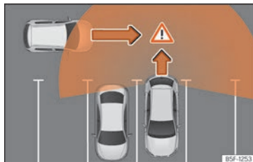
Fig. 161 Representación esquemática del asistente de desaparcamiento: zona vigilada alrededor del vehículo que está desaparcando.
