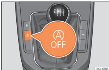
Fig. 132 Consola central: tecla del sistema Start-Stop.
