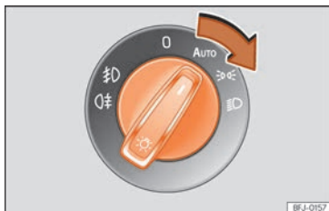
Fig. 92 Tablero de instrumentos: mando de las luces.
