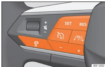
Fig. 157 Lado izquierdo del volante multifunción: teclas para el manejo del Travel Assist.
