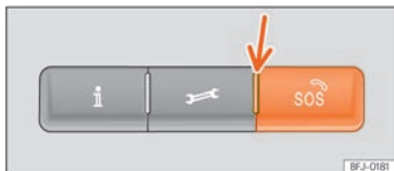
Fig. 29 En la consola del techo: mandos para los servicios de voz
