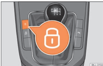
Fig. 82 Consola central: botón del cierre centralizado.
