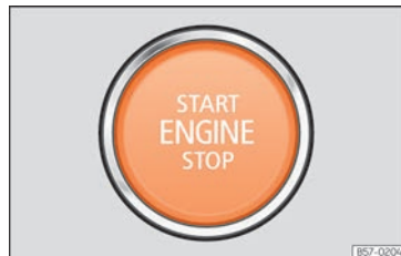
Fig. 130 En la parte inferior de la consola central: pulsador de arranque.
