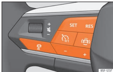
Fig. 149 En el volante multifunción: botones para manejar el ACC
