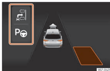
Fig. 164 En la pantalla del cuadro de instrumentos: visualización del sistema de aparcamiento asistido con visualización reducida.
