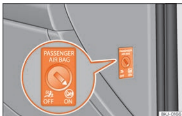
Fig. 16 Conmutador con llave para activar y desactivar el airbag del acompañante.
