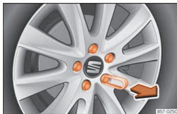
Fig. 33 Rueda: tornillos de la rueda con capuchones.
