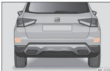
Fig. 142 Vista trasera del vehículo: zonas de los sensores de radar.
