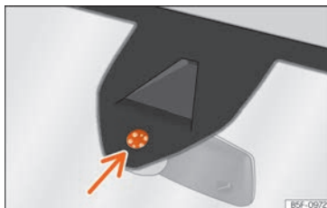
Fig. 100 Superficie sensible del sensor de lluvia.
