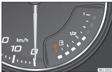
Fig. 65 Cuadro de instrumentos analógico: indicador de nivel de combustible
