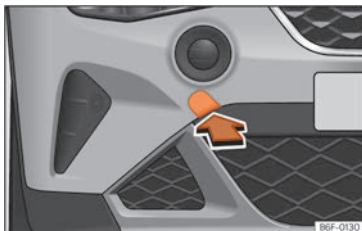
Fig. 44 Parte derecha del parachoques delantero: retirar la tapa.
