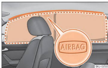
Fig. 20 Ubicación y zona de despliegue del airbag para la cabeza.
