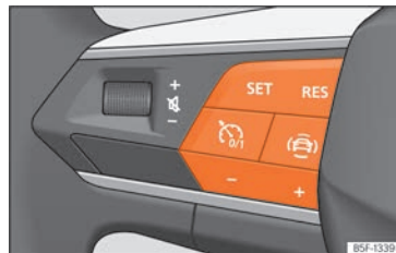
Fig. 146 En el volante multifunción: botones para manejar el limitador de velocidad
