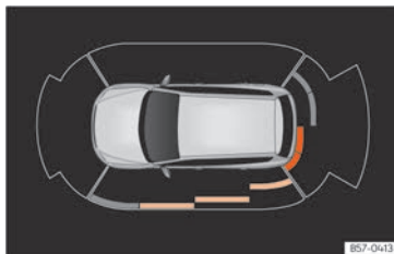
Fig. 171 Visualización de ayuda al aparcamiento en la pantalla del sistema de infotainment.
