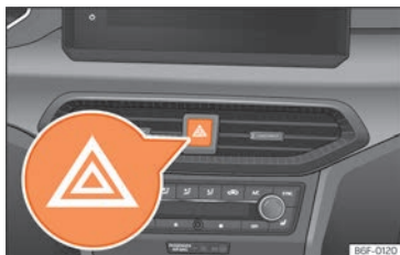
Fig. 95 Tablero de instrumentos: conmutador de los intermitentes de emergencia.
