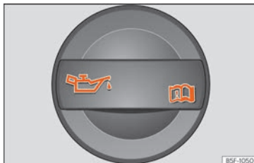
Fig. 195 Tapón de la boca de llenado de aceite del motor en el vano motor.
