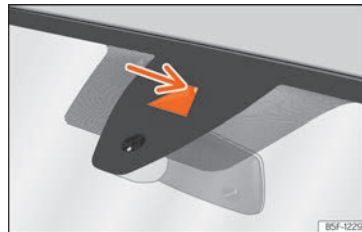
Fig. 141 En el parabrisas: área de campo visual del sistema de aviso de salida del carril.
