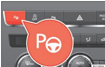
Fig. 202 En la parte superior de la consola central: tecla para conectar el sistema de aparcamiento asistido.
