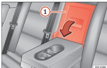
Fig. 154 En el respaldo del asiento trasero: apertura de la trampilla.
