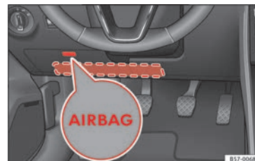
Fig. 23 En el lado del conductor: ubicación del airbag para las rodillas.
