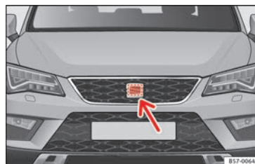
Fig. 187 En el frontal tras el emblema de SEAT: sensor de radar.
