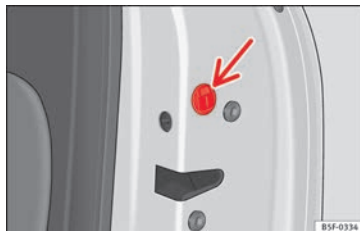
Fig. 4 Bloqueo de emergencia de la puerta.
