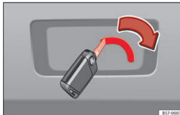
Fig. 8 Detalle del maletero: desbloqueo de emergencia.
