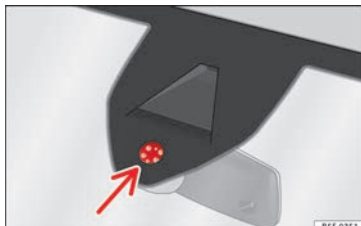
Fig. 141 Superficie sensible del sensor de lluvia.
