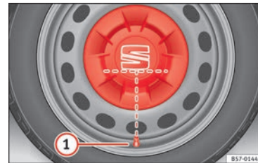
Fig. 69 Colocación correcta del embellecedor central de rueda para llantas de acero.
