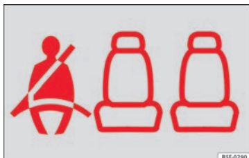
Fig. 87 Cuadro de instrumentos: indicación de plaza posterior derecha ocupada y abrochado el cinturón correspondiente.
