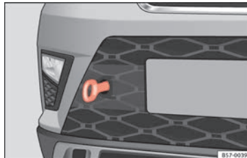
Fig. 75 Parte derecha del parachoques delantero: argolla de remolque enroscada.
