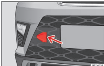
Fig. 97 En el lado derecho del paragolpes delantero: retirar la tapa.
