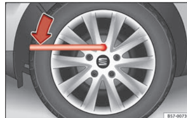
Fig. 72 Rueda: aflojar los tornillos de la rueda.
