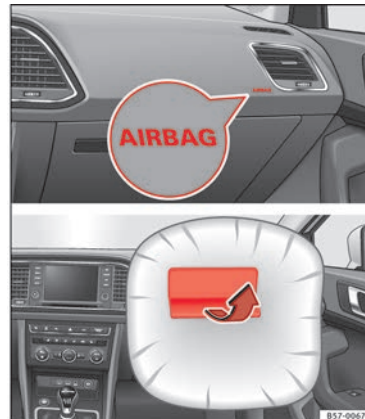
Fig. 21 Airbag del acompañante en el tablero de instrumentos.
