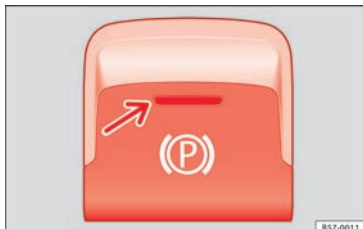
Fig. 167 En la parte inferior de la consola central: tecla del freno de estacionamiento electrónico.
