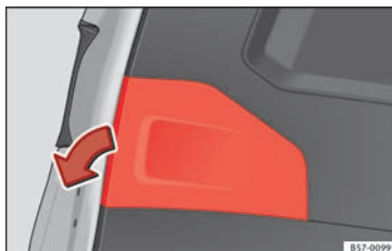
Fig. 112 Portón del maletero abierto: retirar la tapa.
