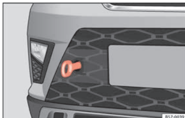
Fig. 98 En el lado derecho del paragolpes delantero: argolla de remolque enroscada.
