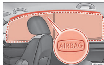
Fig. 27 Ubicación de los airbags para la cabeza.
