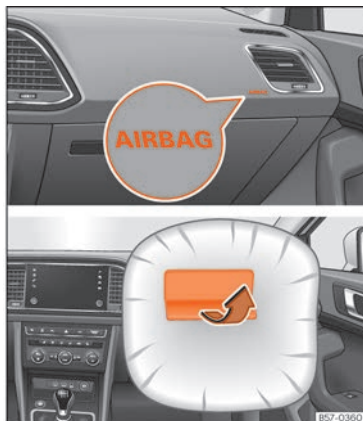
Fig. 16 Airbag del acompañante en el tablero de instrumentos.
