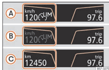
Fig. 253 En la pantalla del cuadro de instrumentos: indicaciones del estado del limitador de velocidad.
