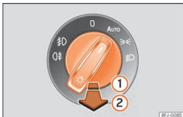
Fig. 113 Tablero de instrumentos: mando de las luces.
