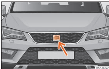
Fig. 257 En el frontal tras el emblema de SEAT: sensor de radar.
