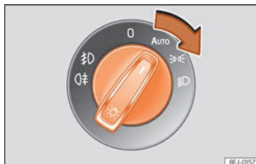
Fig. 112 Tablero de instrumentos: mando de las luces.
