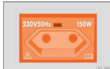
Fig. 151 En el lado izquierdo del maletero: toma de corriente de 230 voltios.
