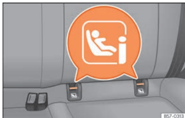
Fig. 28 Asiento trasero: anillas de sujeción ISOFIX/i-Size.
