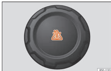
Fig. 314 Vano motor: tapón del depósito de expansión del líquido refrigerante.
