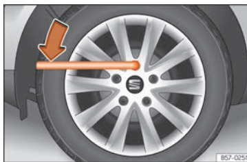
Fig. 38 Cambio de rueda: aflojar los tornillos de rueda.
