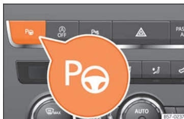
Fig. 282 En la parte superior de la consola central: tecla para conectar el sistema de aparcamiento asistido.
