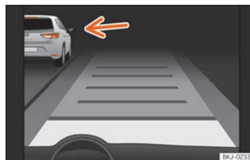
Fig. 266 En la pantalla del cuadro de instrumentos: ACC activo, vehículo detectado por la izquierda
