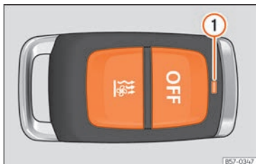
Fig. 157 Calefacción independiente: mando a distancia por radiofrecuencia.
