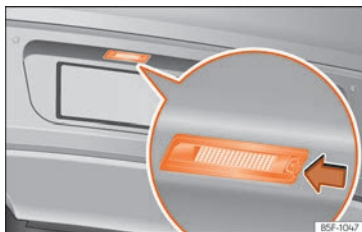
Fig. 65 En el parachoques trasero: luz de matrícula.
