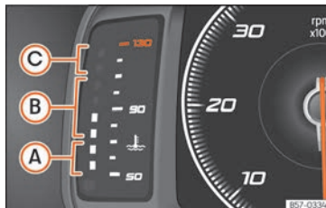
Fig. 78 Cuadro de instrumentos digital: indicador de temperatura del líquido refrigerante del motor.
