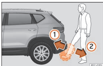
Fig. 103 Portón del maletero con apertura controlada por sensor (Easy Open).
