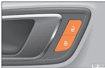
Fig. 92 Puerta del conductor: conmutador del cierre centralizado.
