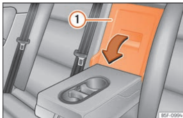
Fig. 142 En el respaldo del asiento trasero: apertura de la trampilla.
