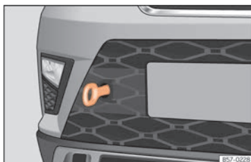
Fig. 48 En el lado derecho del paragolpes delantero: argolla de remolque enroscada.
