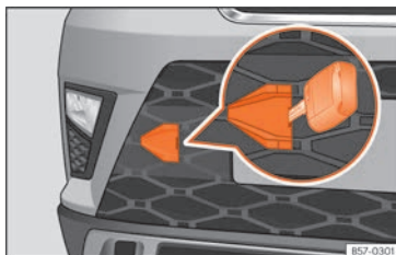
Fig. 47 En el lado derecho del paragolpes delantero: retirar la tapa.
