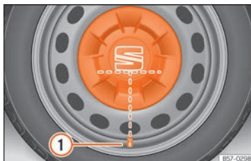
Fig. 35 Colocación correcta del embellecedor central de rueda para llantas de acero.
