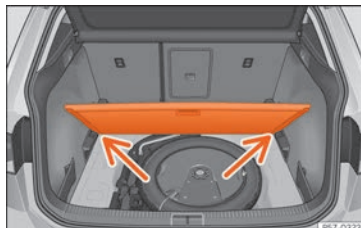
Fig. 137 Suelo variable del maletero: posición inclinada.
