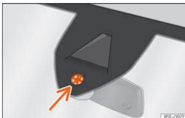
Fig. 156 Sensor de humedad y temperatura del parabrisas.
