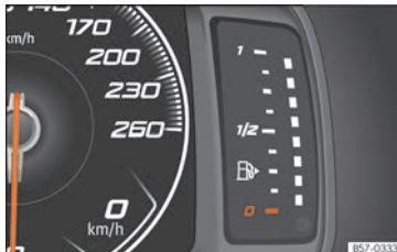
Fig. 76 Cuadro de instrumentos digital: indicador del nivel de combustible.
