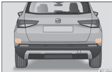
Fig. 275 Vista trasera del vehículo: zonas de los sensores de radar.
