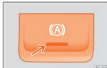
Fig. 280 En la parte inferior de la consola central: tecla de la función Auto Hold.
