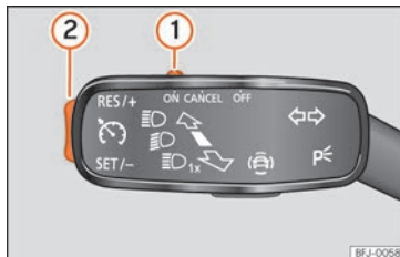
Fig. 252 En la palanca de los intermitentes: mandos para el manejo del GRA.
