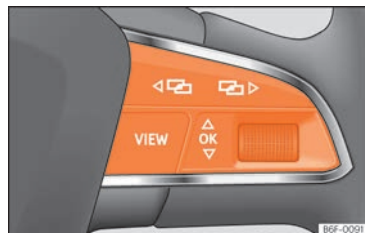
Fig. 80 Lado derecho del volante multifunción: teclas para utilizar los menús y las indicaciones informativas del cuadro de instrumentos.
