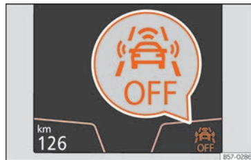
Fig. 258 En la pantalla del cuadro de instrumentos: indicación de Front Assist desactivado.
