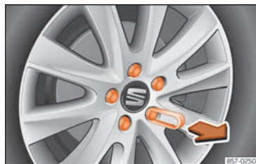
Fig. 36 Rueda: tornillos de la rueda con capuchones.
