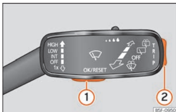
Fig. 79 Palanca del limpiaparabrisas: teclas de control.
