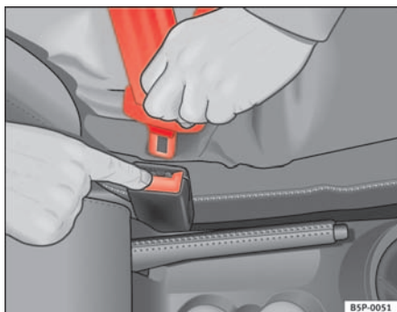
Fig. 15 Retirar la lengüeta del cierre del cinturón
