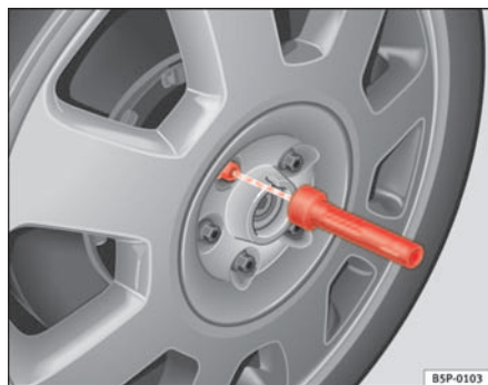
Fig. 136 Cambio de rueda: Útil de hexágono interior para girar los tornillos
