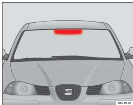
Fig. 65 Área de ubicación del telepeaje (superficie roja)
