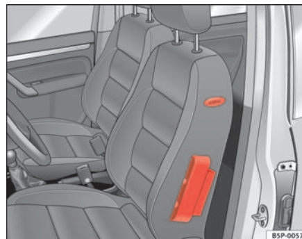
Fig. 20 Airbag lateral en el asiento del conductor
