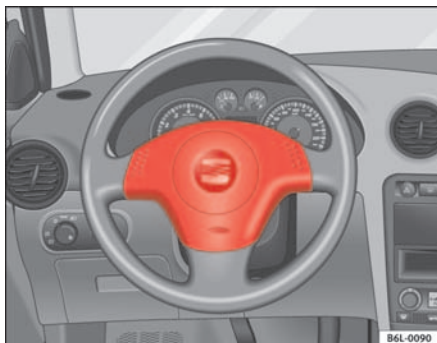
Fig. 16 Airbag del conductor en el volante
