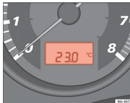
Fig. 35 Pantalla digital del cuadro de instrumentos: indicador de la temperatura exterior
