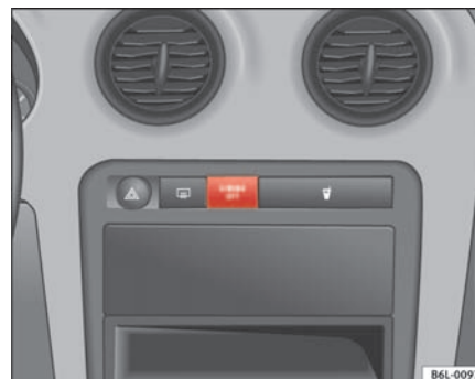
Fig. 25 Testigo de control de la desactivación del airbag del acompañante
