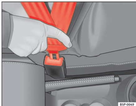
Fig. 11 Cierre y lengüeta del cinturón de seguridad
