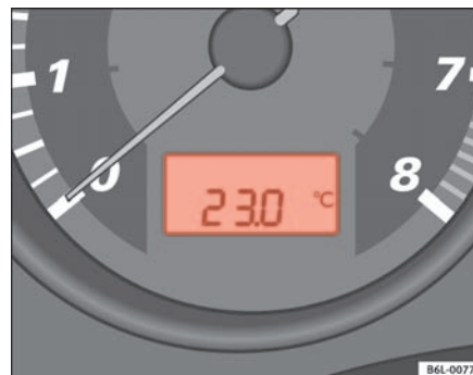
Fig. 37 Pantalla digital del cuadro de instrumentos: indicador temperatura exterior.
