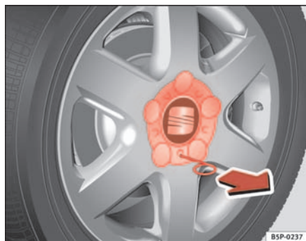
Fig. 131 Cambio de rueda: Retirar el embellecedor de la rueda
