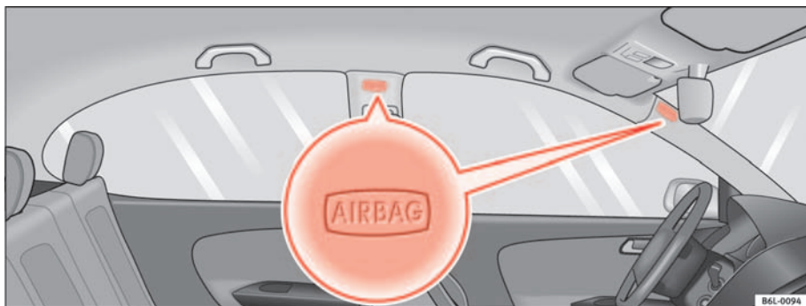
Fig. 22 Ubicación de los airbags para la cabeza en el lado izquierdo del vehículo
