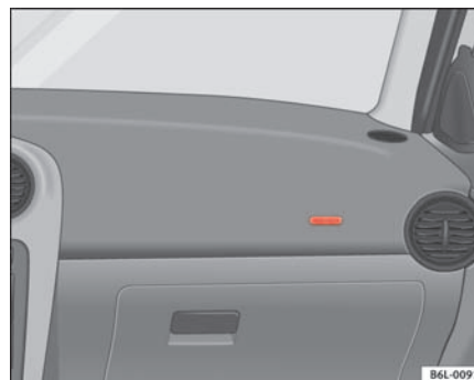
Fig. 17 Airbag del acompañante en el tablero de instrumentos
