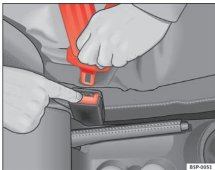
Fig. 15 Retirar la lengüeta del cierre del cinturón
