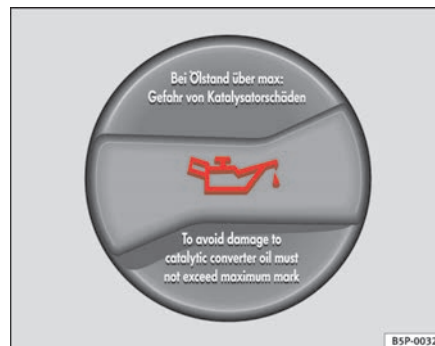
Fig. 124 Tapón de la boca de llenado de aceite del motor en el vano motor
