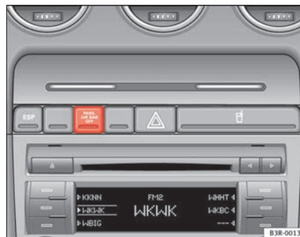
Fig. 28 Testigo de control de la desactivación del airbag del acompañante
