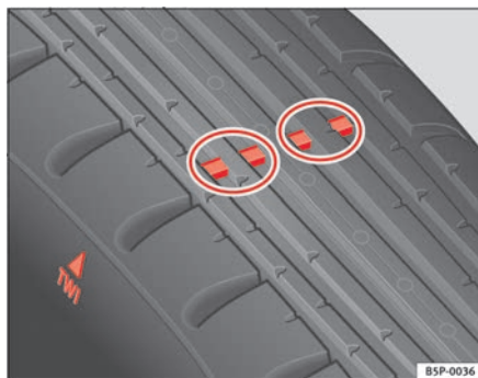
Fig. 173 Indicadores de desgaste del perfil del neumático
