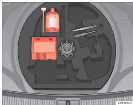
Fig. 176 Juego para reparación de neumáticos (tire mobility system) debajo de la superficie de carga del maletero
