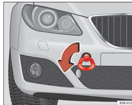
Fig. 226 Atornillado de la argolla de remolque en la parte delantera del vehículo
