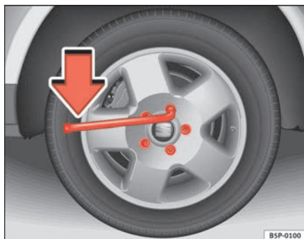
Fig. 178 Cambio de rueda: Aflojar los tornillos de la rueda
