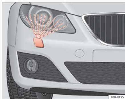
Fig. 101 Faro con eyector de lavado desplegado
