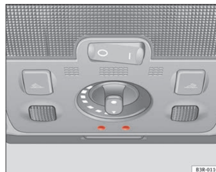
Fig. 93 Detalle del revestimiento del techo: iluminación ambiental
