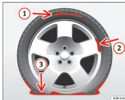
Fig. 183 Pinchazos para los que no se adecua el sistema tire mobility system
