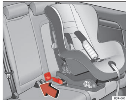
Fig. 33 Los anclajes ISOFIX del asiento infantil se deslizan por las guías de plástico ya montadas hasta fijarlos en los anclajes ISOFIX del vehículo
