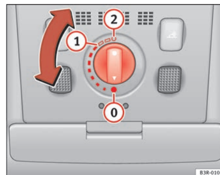
Fig. 80 Detalle del revestimiento del techo: Mando giratorio para el techo corredizo/deflector
