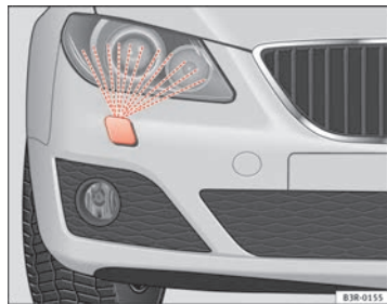
Fig. 102 Faro con eyector de lavado desplegado
