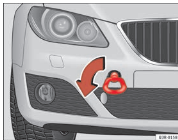
Fig. 231 Atornillado de la argolla de remolque en la parte delantera del vehículo
