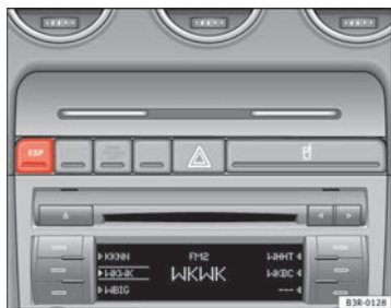
Fig. 149 Consola central con el interruptor del ESP
