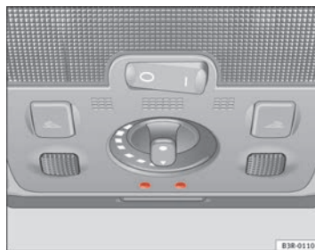
Fig. 94 Detalle del revestimiento del techo: Iluminación ambiental
