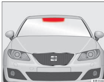
Fig. 162 Área de ubicación del telepeaje
