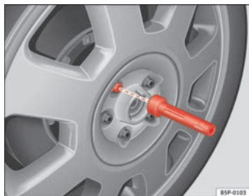
Fig. 182 Cambio de rueda: Útil de hexágono interior para girar los tornillos
