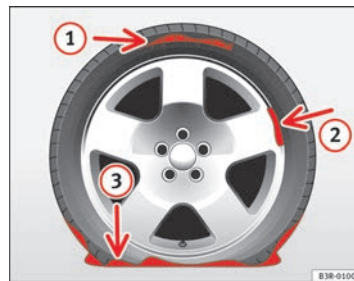
Fig. 184 Pinchazos para los que no se adecua el sistema tire mobility system
