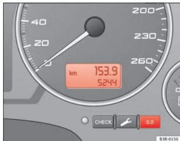
Fig. 42 Detalle del cuadro de instrumentos: Cuenta-kilómetros
