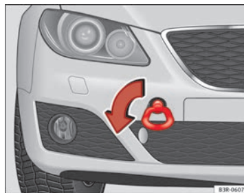
Fig. 242 Atornillado de la argolla de remolque en la parte delantera del vehículo
