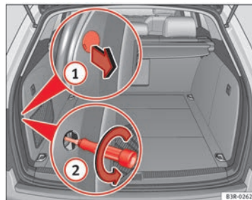
Fig. 220 Maletero: Posición del tornillo de fijación para la unidad de luz trasera
