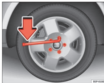
Fig. 193 Cambio de rueda: Aflojar los tornillos de la rueda
