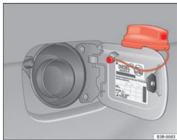
Fig. 174 Tapa del depósito con el tapón encajado
