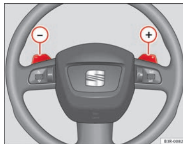
Fig. 159 Volante: Mandos del tiptronic
