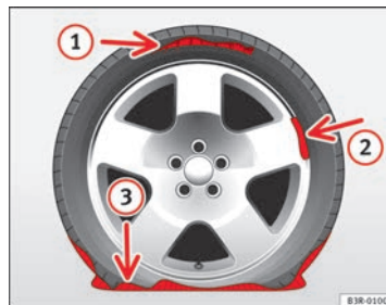
Fig. 197 Pinchazos para los que no se adecua el sistema tire mobility system
