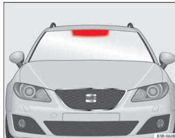
Fig. 173 Área de ubicación del telepeaje
