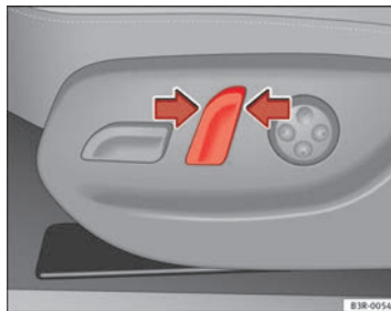
Fig. 109 Asiento delantero: Mando para la inclinación del respaldo
