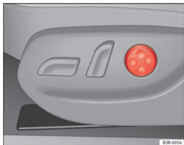
Fig. 110 Asiento delantero: Placa reguladora para apoyo lumbar
