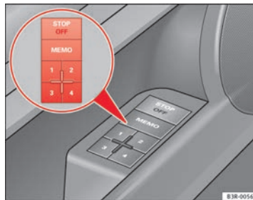
Fig. 111 Puerta del conductor: Sistema de memoria
