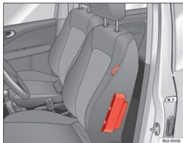
Fig. 23 Airbag lateral en el asiento del conductor
