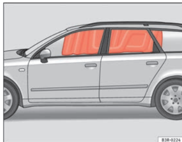
Fig. 26 Airbags para la cabeza inflados
