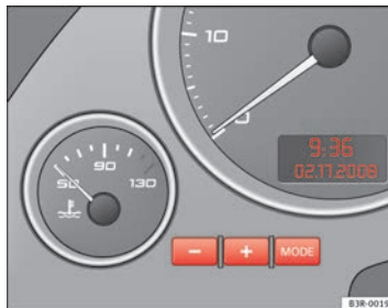
Fig. 40 Detalle del cuadro de instrumentos: Reloj digital
