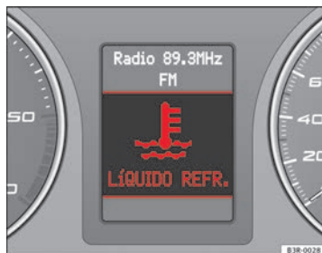
Fig. 54 Pantalla: Aviso sobre el nivel del líquido refrigerante
