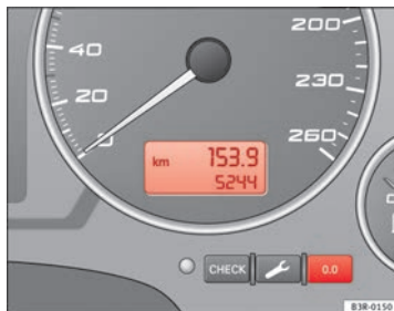
Fig. 42 Detalle del cuadro de instrumentos: Cuentakilómetros
