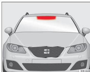
Fig. 176 Área de ubicación del telepeaje
