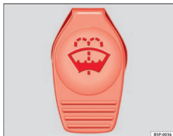
Fig. 183 Tapón del depósito del lavacristales en el vano motor.
