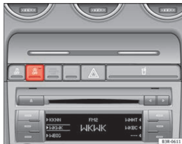
Fig. 147 Detalle del pulsador del funcionamiento Start-Stop.
