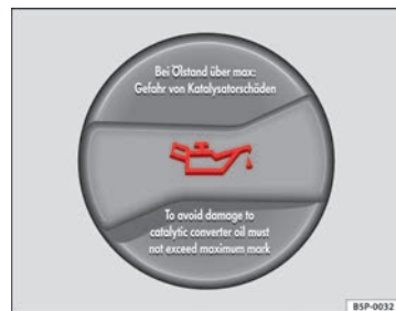
Fig. 181 Tapón de la boca de llenado de aceite del motor en el vano motor
