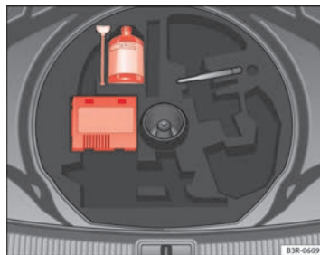
Fig. 194 Juego para reparación de neumáticos (tire mobility system) debajo de la superficie de carga del maletero
