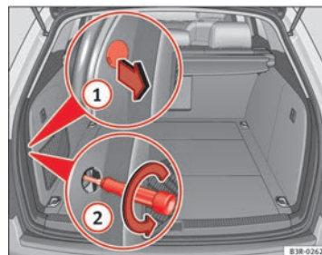
Fig. 223 Maletero: Posición del tornillo de fijación para la unidad de luz trasera
