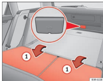
Fig. 75 Detalle de la parte trasera del habitáculo y del maletero: acceso al dispositivo para apertura de emergencia
