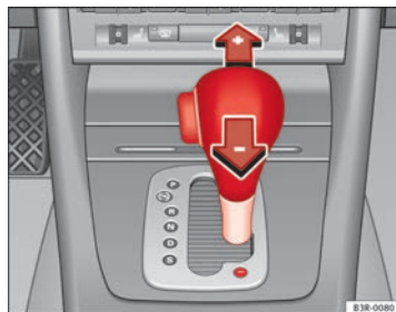
Fig. 160 Consola central: Cambiar las marchas manualmente (modo tiptronic)
