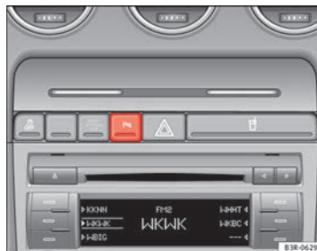
Fig. 153 Consola central: interruptor para ayuda de aparcamiento
