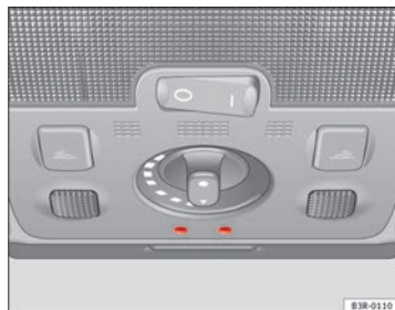
Fig. 93 Detalle del revestimiento del techo: iluminación ambiental
