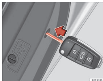
Fig. 73 Activar el bloqueo de emergencia
