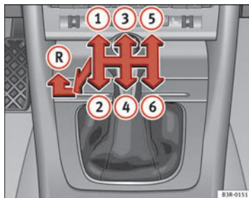
Fig. 156 Detalle de la consola central: esquema de un cambio manual de 6 marchas
