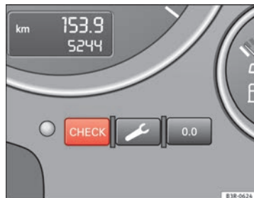
Fig. 43 Detalle del cuadro de instrumentos: Tecla CHECK
