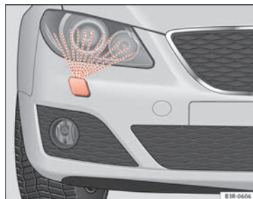
Fig. 101 Faro con eyector de lavado desplegado
