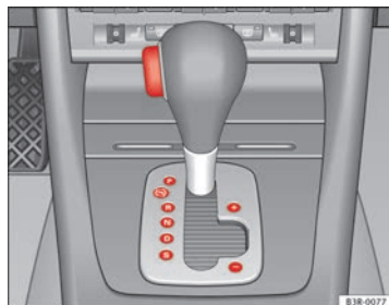
Fig. 157 Detalle de la consola central: Palanca selectora con tecla de bloqueo
