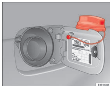
Fig. 177 Tapa del depósito con el tapón encajado
