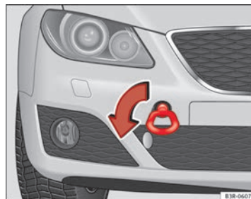
Fig. 246 Atornillado de la argolla de remolque en la parte delantera del vehículo
