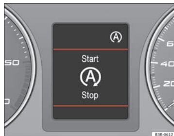
Fig. 148 Indicación en la pantalla del cuadro de instrumentos durante el funcionamiento Start-Stop.
