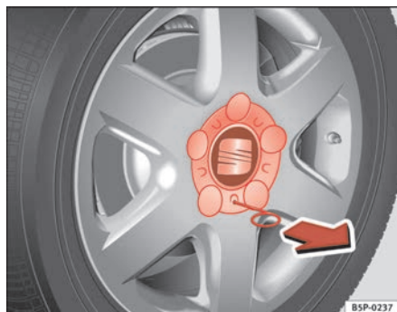
Fig. 139 Cambio de rueda: Retirar el embellecedor de la rueda
