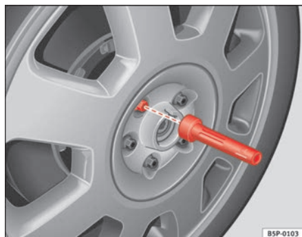
Fig. 144 Cambio de rueda: Útil de hexágono interior para girar los tornillos
