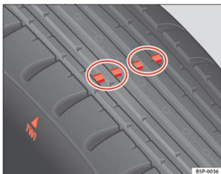
Fig. 134 Indicadores de desgaste del perfil del neumático
