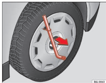
Fig. 126 Retirar embellecedor integral
