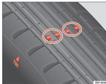
Fig. 124 Indicadores de desgaste del perfil del neumático
