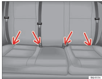
Fig. 26 Anillas de sujeción ISOFIX
