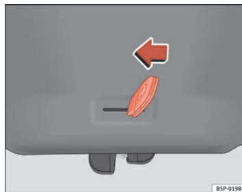
Fig. 47 Portón trasero: apertura de emergencia
