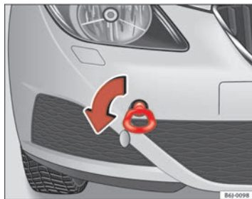
Fig. 156 Atornillado de la argolla de remolque en la parte delantera del vehículo
