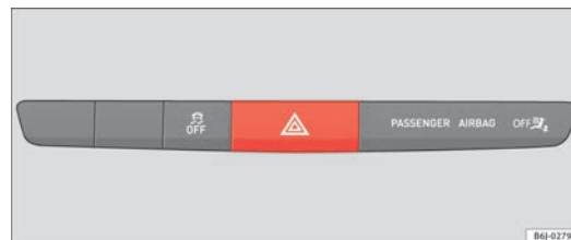
Fig. 59 Tablero de instrumentos: conmutador de los intermitentes de emergencia
