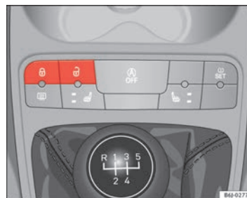
Fig. 43 Pulsador del cierre centralizado
