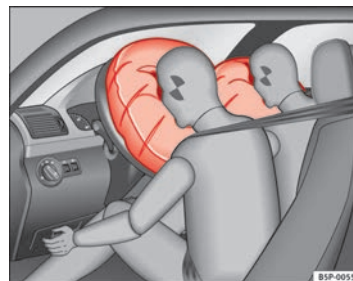
Fig. 18 Airbags frontales inflados
