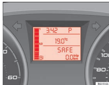
Fig. 114 Cambio automático: pantalla del cuadro de instrumentos
