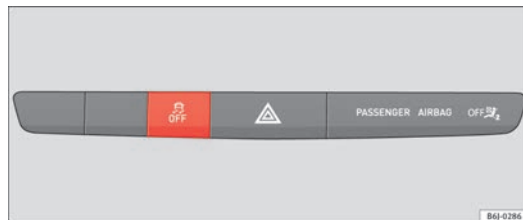
Fig. 106 Detalle del tablero de instrumentos: tecla ESC.
