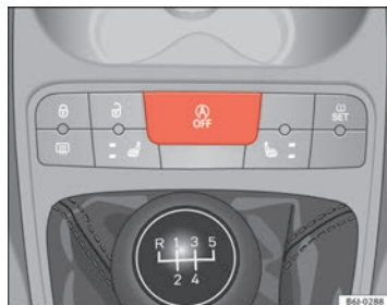
Fig. 109 Detalle del pulsador del funcionamiento Start-Stop.
