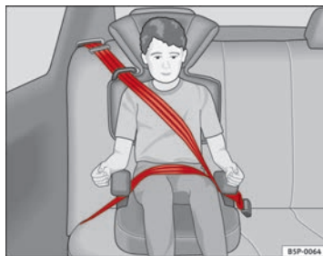
Fig. 25 Asiento para niños montado en el asiento trasero en la dirección de la marcha.
