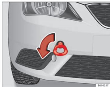
Fig. 180 Atomillado de la argolla de remolque en la parte delantera del vehículo
