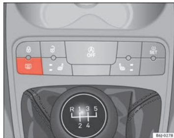
Fig. 58 Consola central: conmutador de luneta térmica
