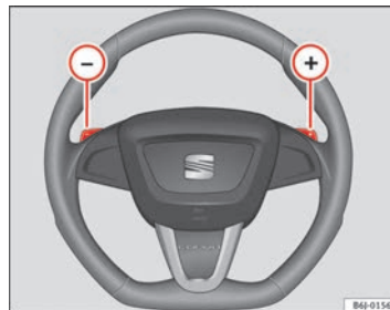
Fig. 117 Volante con levas para cambio automático
