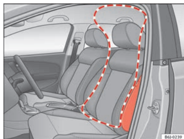
Fig. 20 Airbag lateral en el asiento del conductor
