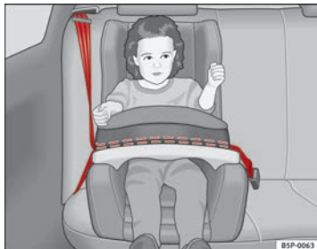
Fig. 24 Asiento para niños del grupo 1 montado en el asiento trasero en la dirección de la marcha.
