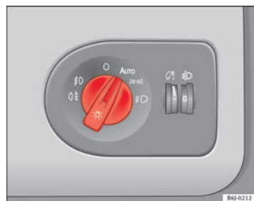
Fig. 55 Encendido automático de luces
