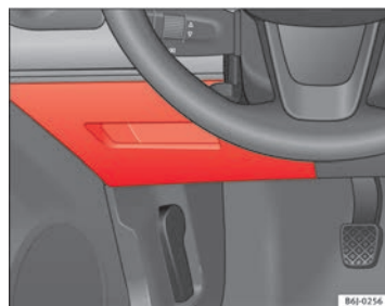
Fig. 149 Fusibles en tablero de instrumentos
