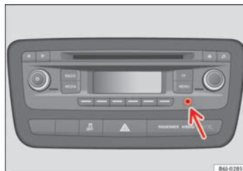
Fig. 89 Conexión AUX en consola central (en función del equipamiento)
