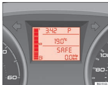
Fig. 118 Cambio automático: Pantalla del cuadro de instrumentos
