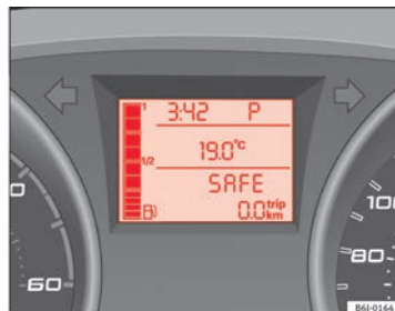
Fig. 36 Pantalla digital: Posición de la palanca del cambio automático
