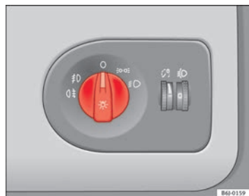
Fig. 54 Detalle del tablero de instrumentos: mando de las luces, faros antiniebla y luz trasera antiniebla
