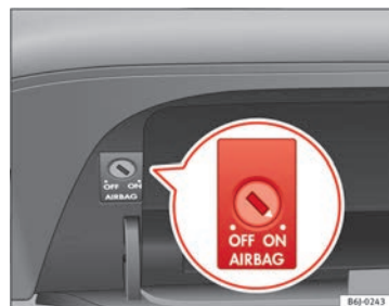
Fig. 21 En la guantera: conmutador con llave para activar y desactivar el airbag del acompañante
