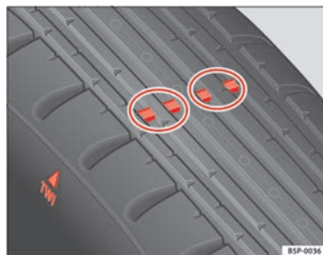
Fig. 142 Indicadores de desgaste del perfil del neumático
