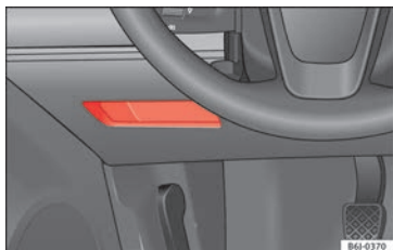
Fig. 105 Compartimento en el lado del conductor.
