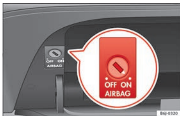
Fig. 61 En la guantera: conmutador con llave para activar y desactivar el airbag del acompañante.
