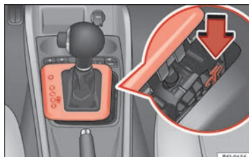
Fig. 169 Desbloqueo de emergencia de la palanca selectora.
