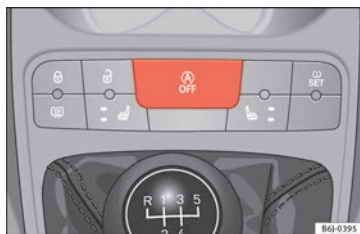
Fig. 141 Detalle del pulsador del funcionamiento Start-Stop.
