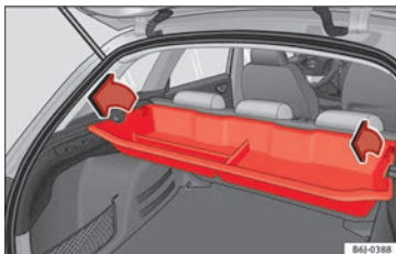
Fig. 121 Maletero: desmontaje del cajón portaobjetos.
