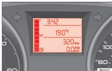
Fig. 72 Cuadro de instrumentos: indicador de nivel del depósito de combustible.
