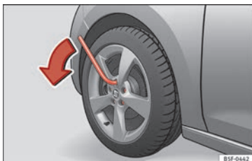
Fig. 159 Cambio de rueda: aflojar los tornillos de rueda.
