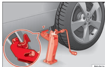
Fig. 161 Colocación del gato.
