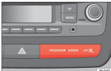
Fig. 62 Parte central del tablero de instrumentos: testigo de control de la desactivación del airbag del acompañante.
