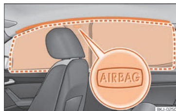
Fig. 29 Ubicación y zona de despliegue del airbag para la cabeza.
