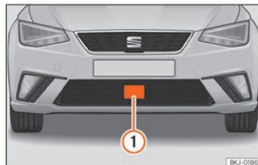
Fig. 232 En el paragolpes delantero: sensor de radar.
