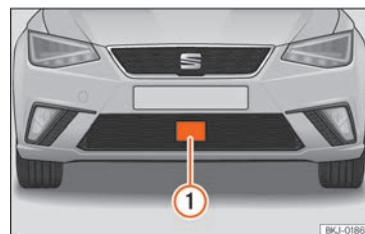
Fig. 237 En el paragolpes delantero: sensor de radar.
