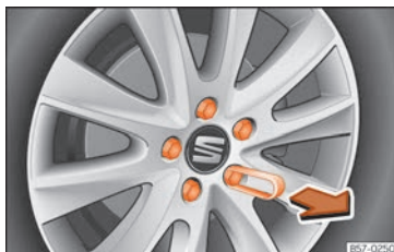
Fig. 73 Rueda: tornillos de la rueda con capuchones.
