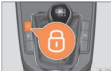
Fig. 5 Consola central: pulsadores del cierre centralizado.
