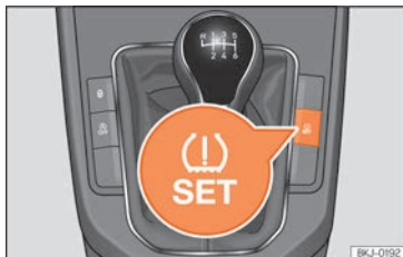
Fig. 274 Consola central: tecla del sistema de control de los neumáticos.
