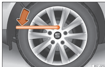
Fig. 74 Cambio de rueda: aflojar los tornillos de rueda.
