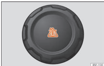
Fig. 61 Vano motor: tapón del depósito de expansión del líquido refrigerante.
