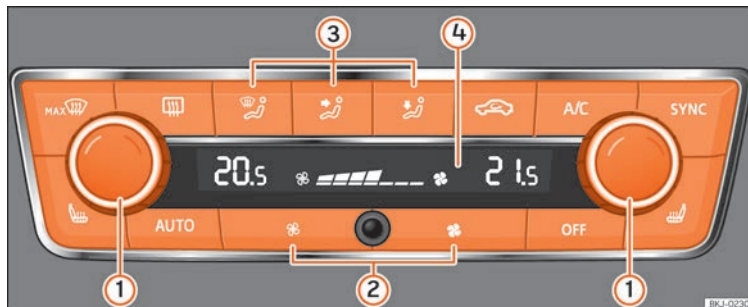
Fig. 56 En la consola central: mandos del Climatronic.
