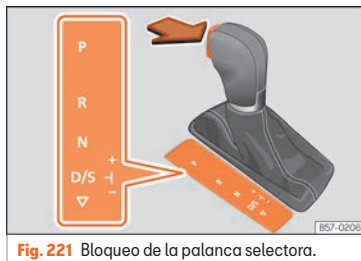
Fig. 221 Bloqueo de la palanca selectora.
