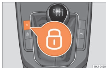
Fig. 134 Pulsador del cierre centralizado.
