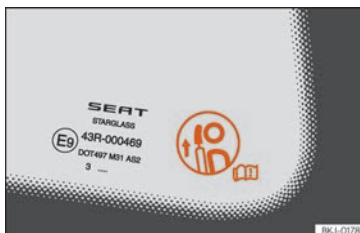
Fig. 89 Etiqueta de advertencia de la posición del apoyacabezas.
