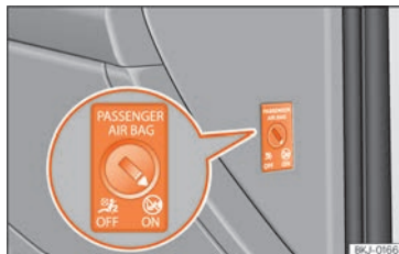
Fig. 25 Conmutador del airbag frontal del acompañante.
