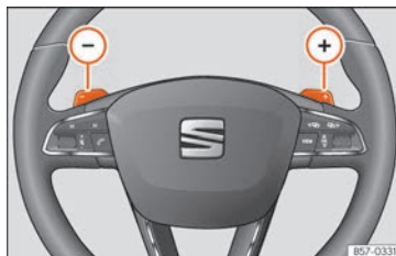
Fig. 223 Volante: palancas para cambio automático.
