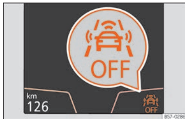
Fig. 233 En la pantalla del cuadro de instrumentos: indicación de Front Assist desactivado.
