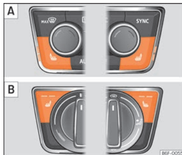
Fig. 151 En la consola central: mandos para la calefacción de los asientos delanteros. [A]: versión con Climatronic. [B]: versión con aire acondicionado manual.
