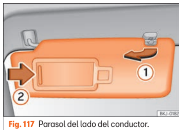
Fig. 117 Parasol del lado del conductor.
