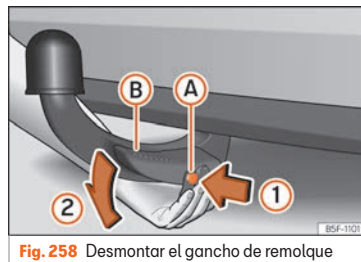
Fig. 258 Desmontar el gancho de remolque
