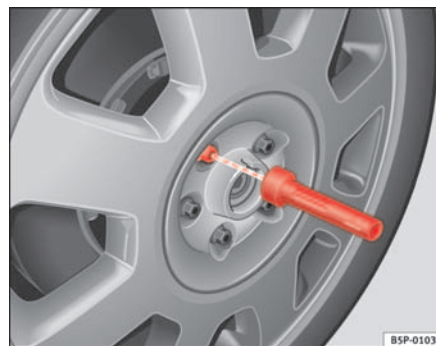
Fig. 158 Cambio de rueda: Útil de hexágono interior para girar los tornillos
