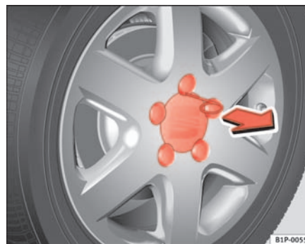
Fig. 154 Cambio de rueda: Retirar el embellecedor de la rueda
