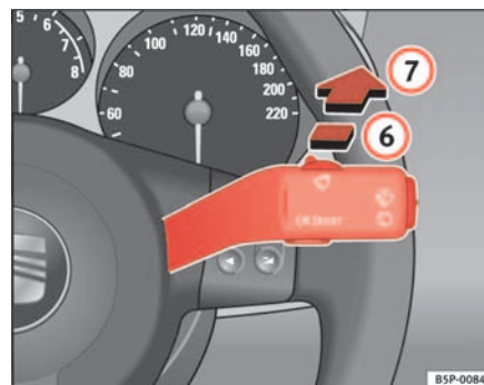
Fig. 84 Palanca del limpiacristales: limpiacristales
