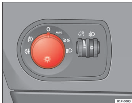
Fig. 73 Encendido automático de luces
