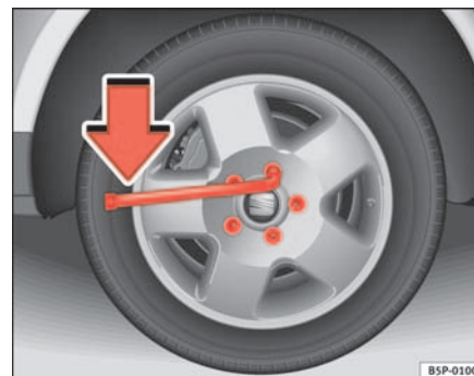
Fig. 155 Cambio de rueda: aflojar los tornillos de rueda
