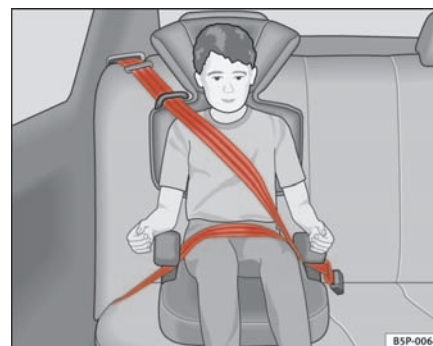
Fig. 29 Asiento para niños montado en el asiento trasero en la dirección de la marcha.
