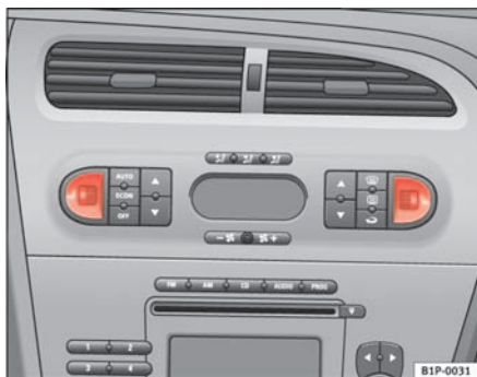
Fig. 91 Ruedecillas moleteadas de la calefacción de los asientos delanteros
