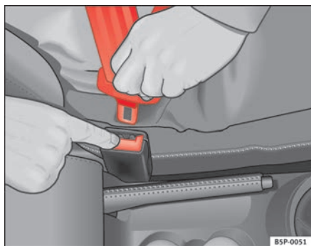
Fig. 15 Retirar la lengüeta del cierre del cinturón
