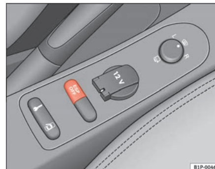
Fig. 115 Detalle de la consola central: tecla ESP
