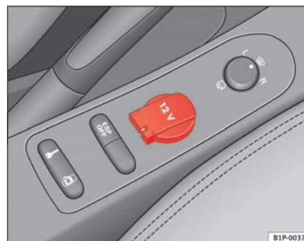
Fig. 101 Toma de corriente consola central delantera
