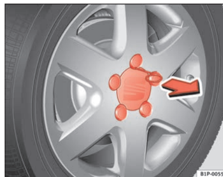
Fig. 154 Cambio de rueda: Retirar el embellecedor de la rueda
