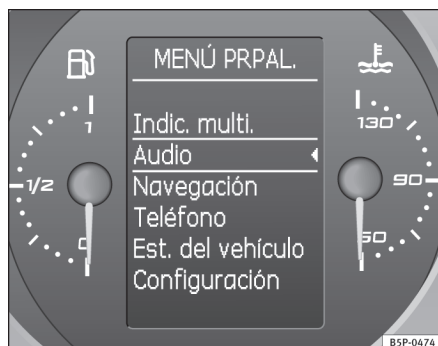
Fig. 45 Pantalla digital del cuadro de instrumentos: Menú principal
