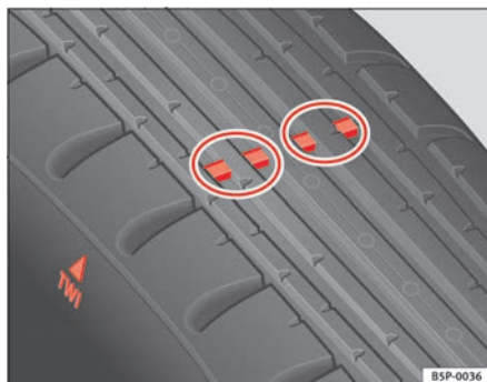
Fig. 147 Indicadores de desgaste del perfil del neumático
