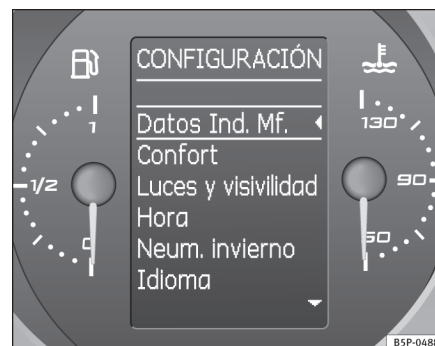
Fig. 46 Pantalla del cuadro de instrumentos indicador multifunción (MFA).
