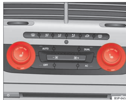
Fig. 92 Calefacción asientos delanteros con Climatronic
