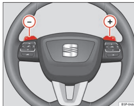
Fig. 126 Volante con palancas para cambio automático
