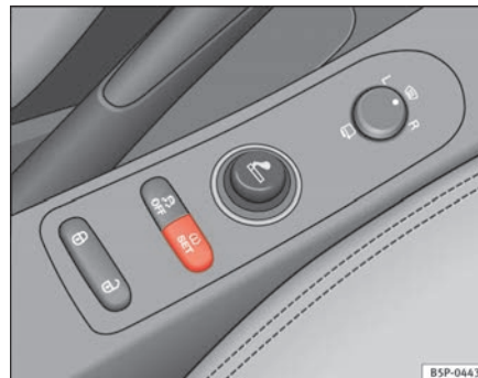
Fig. 48 Consola central: tecla del sistema de control de los neumáticos ►
