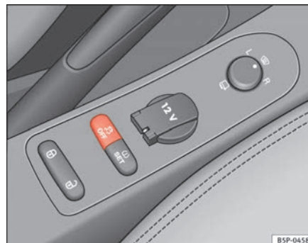
Fig. 117 Detalle de la consola central: tecla ESP
