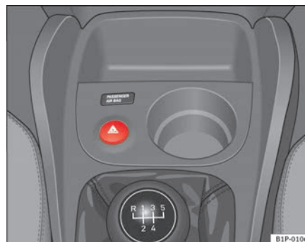
Fig. 75 Tablero de instrumentos: conmutador de los intermitentes de emergencia
