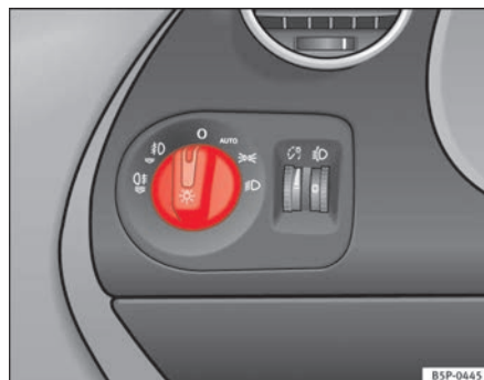
Fig. 71 Detalle del tablero de instrumentos: mando de las luces, faros antiniebla y luz trasera antiniebla
