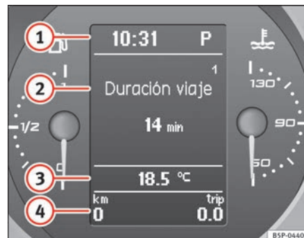
Fig. 36 Pantalla digital del cuadro de instrumentos
