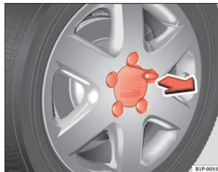
Fig. 150 Cambio de rueda: Retirar el embellecedor de la rueda
