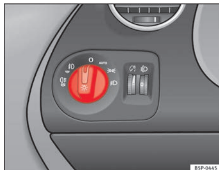
Fig. 72 Encendido automático de luces
