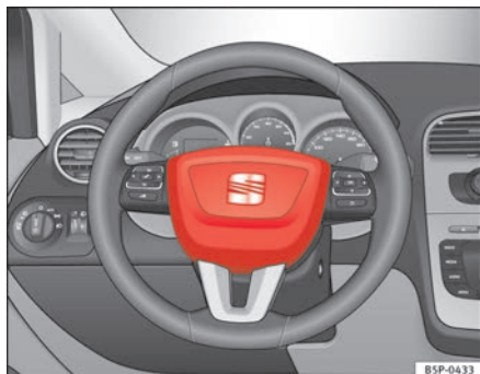
Fig. 17 Airbag del conductor en el volante
