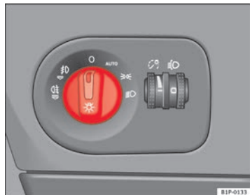
Fig. 71 Encendido automático de luces
