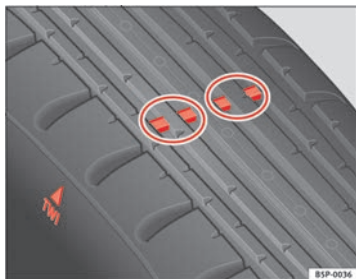
Fig. 151 Indicadores de desgaste del perfil del neumático
