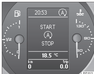
Fig. 119 Indicación en la pantalla del cuadro de instrumentos durante el funcionamiento Start-Stop.
