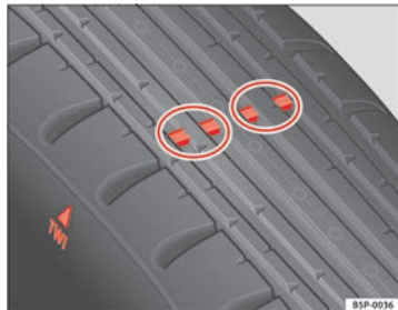
Fig. 115 Perfil del neumático: indicadores de desgaste
