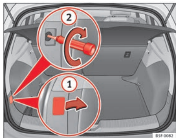
Fig. 143 Maletero: Posición del tornillo de fijación para la unidad de luz trasera
