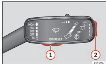
Fig. 40 Vehículos sin volante multifunción: Tecla ① en la palanca del limpiaparabrisas para confirmar las opciones del menú y tecla basculante ② para cambiar de menú.
